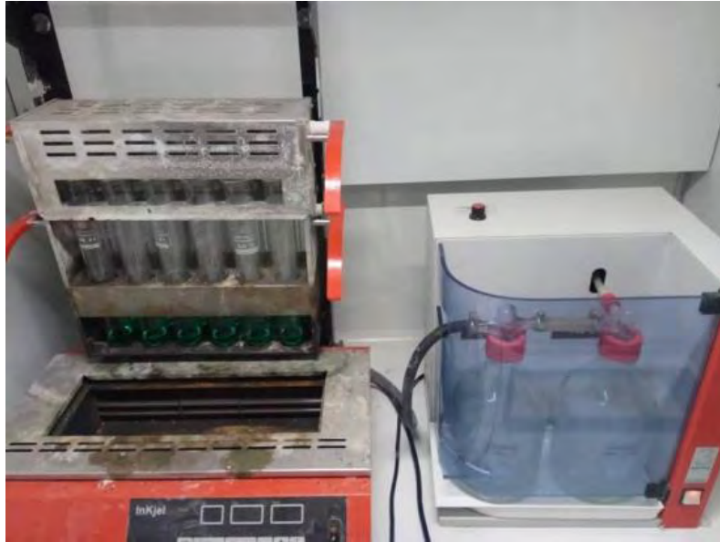
Εικόνα 11: Διαδικασία της πέψης στη συσκευή Kjeltec
