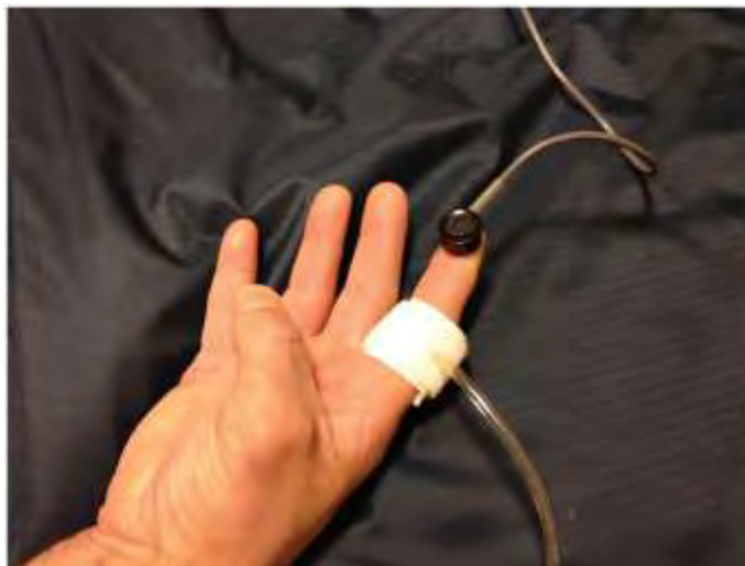
Εικόνα 14: Ανιχνευτής φωτοπληθυσμογράφου τοποθετημένος στην άκρη του δακτύλου με κολλητική ταινία διπλής όψευς και περιχειρίδα τοποθετημένη στη βάση του δακτύλου 3-4 εκ. χαμηλότερα. [7]
