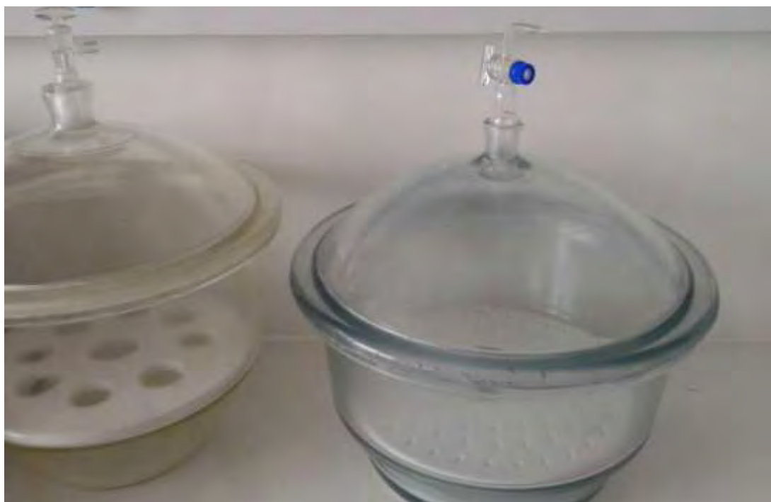
Εικόνα 112: Ξηραντήρες που χρησιμοποιήθηκαν για αποστείρωση των εδαφών με χλωροφόρμιο
