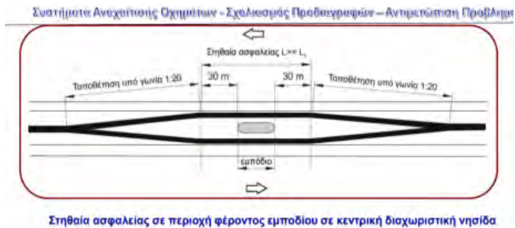
Σχήμα 3: Στηθαία ασφαλείας σε περιοχή φέροντος εμποδίου σε κεντρική διαχωριστική νησίδα (Πηγή: (ΥΠ.Υ.ΜΕ.ΔΙ. - Γ.Γ.Δ.Ε., 2010))
