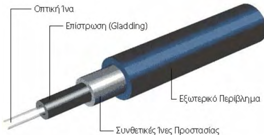
Εικόνα 3.1 Δομή οπτικής ίνας (Technomat, 2019)
