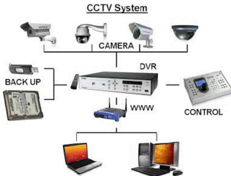
Εικόνα 6.4 Σύστημα Κλειστού Κυκλώματος Τηλεόρασης (CCTV) (Chumuang, Ketcham, Yingthawornsuk, 2018)
