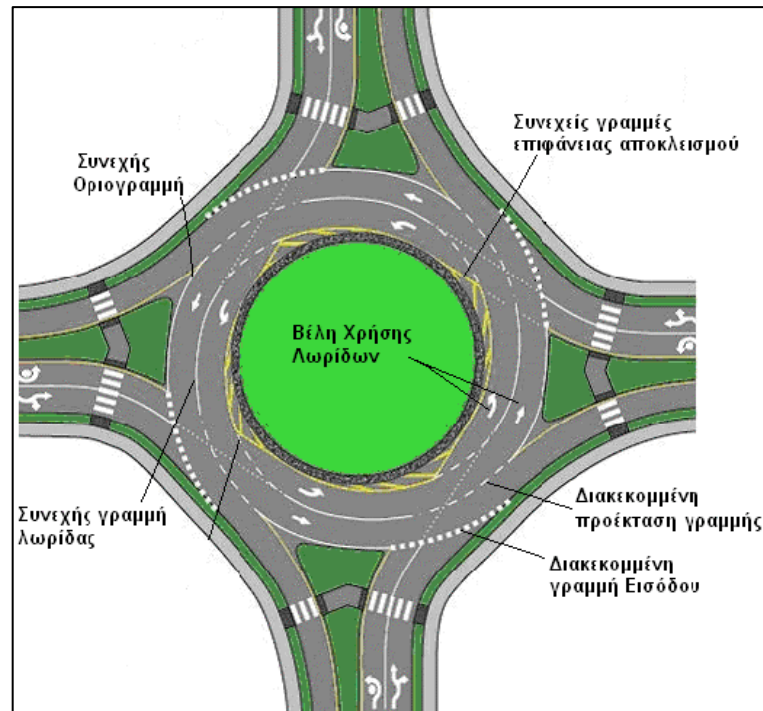
Εικόνα 3.21 Τυπική διάταξη σπειροειδούς κυκλικού κόμβου [20]
