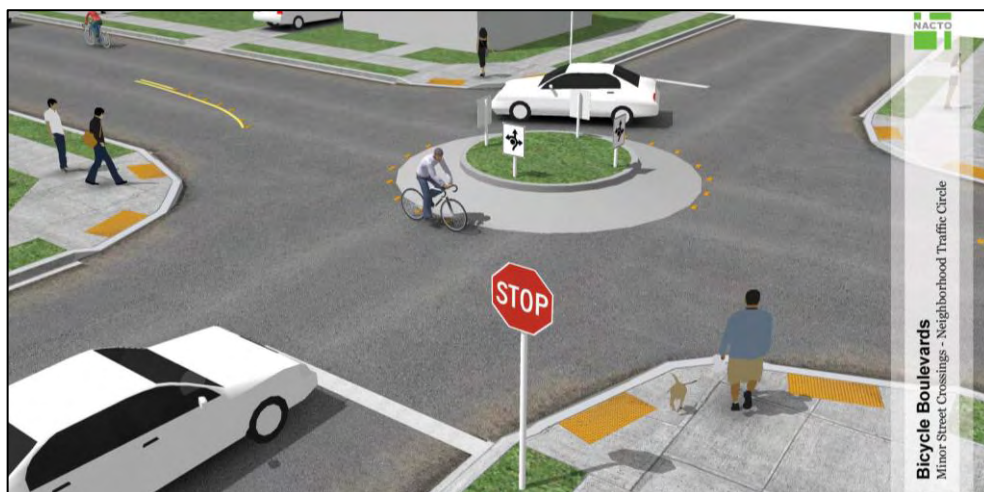
Εικόνα 3.4 Τρισδιάστατη απεικόνιση κυκλοφοριακού κύκλου γειτονιάς [23]
