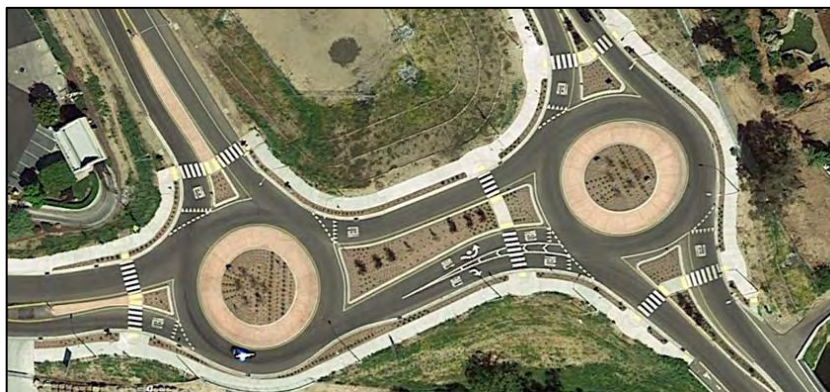
Εικόνα 4.4 Διαμόρφωση κυκλικών κόμβων σε εγγύτητα [38]
