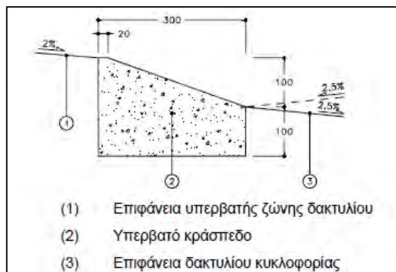
Εικόνα 5.29 Τυπική διατομή μεταβατικού (υπερβατού) κράσπεδου [20]
