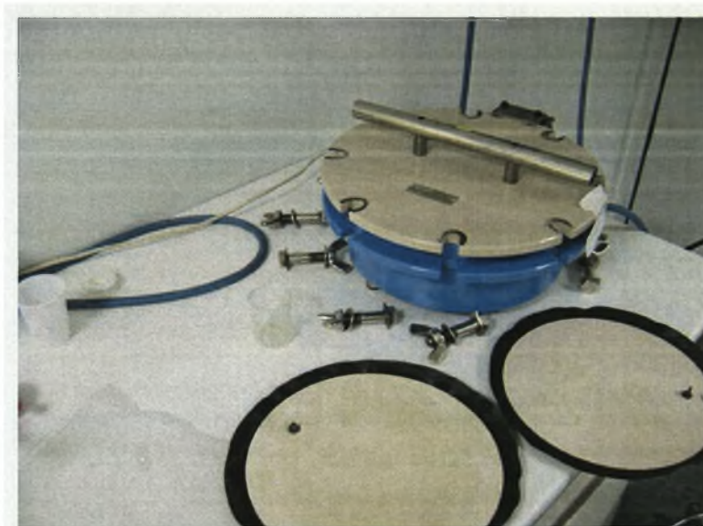
ΕΙΚΟΝΑ 1.8: Η συσκευή Richards και δίσκοι πίεσεως 1atm και 15atm.
