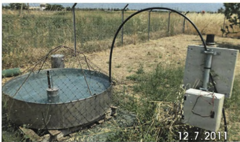
ΕΙΚΟΝΑ 2.8: Ο αισθητήρας Envirosmart και η κεφαλή ελέγχου με τα φίλτρα, την ηλεκτροβάννα και τον data logger.
