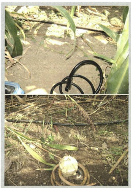
ΕΙΚΟΝΑ 2.7: Διάταξη αισθητήρα Moisture Point.
