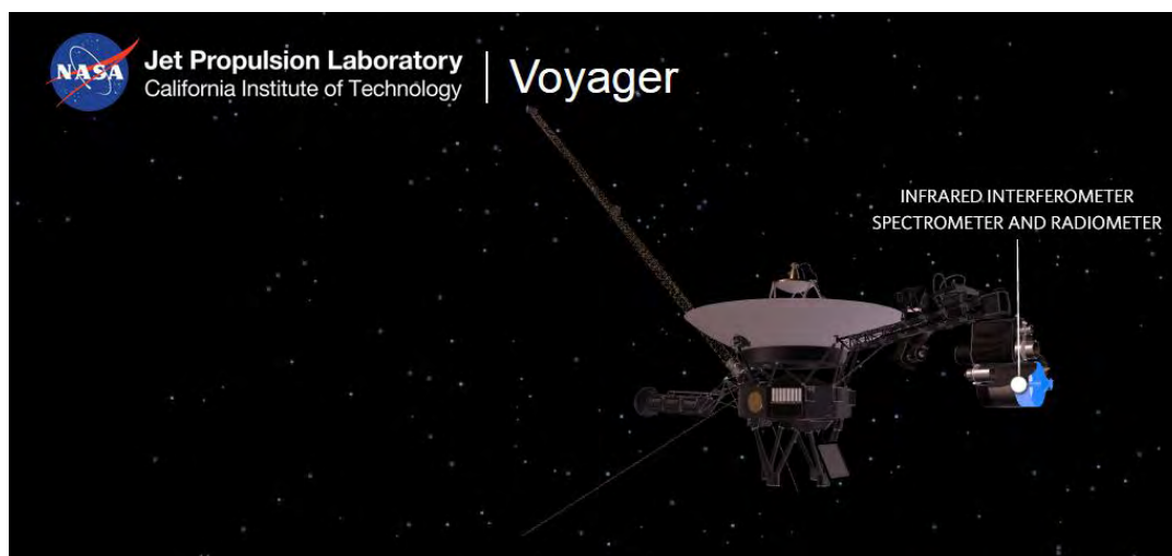
Εικόνα 17: Ο ραδιομετρητής IRIS, [ https://voyager.jpl.nasa.gov/mission/spacecraft/interactive.php ].
