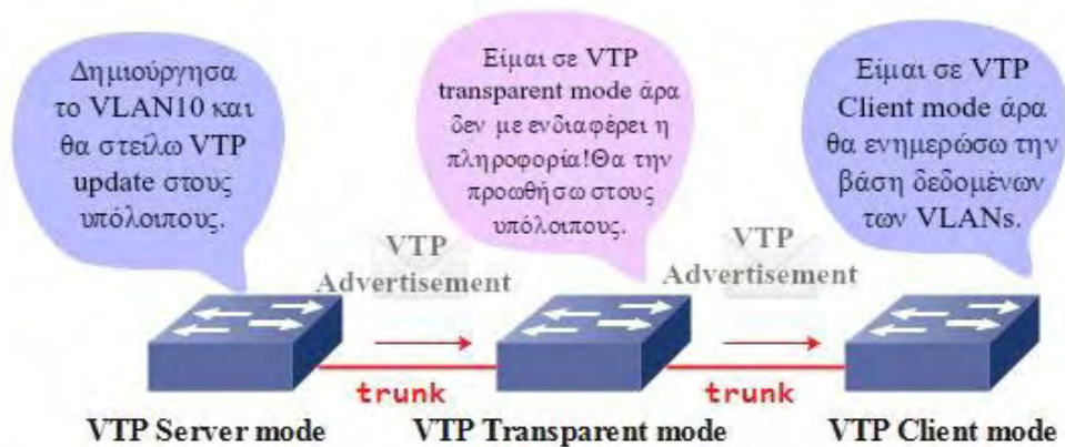
Παράδειγμα των τριών καταστάσεων λειτουργίας VTP
