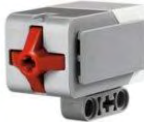
Εικόνα 3.7: Ο αισθητήρας αφής Touch Sensor
