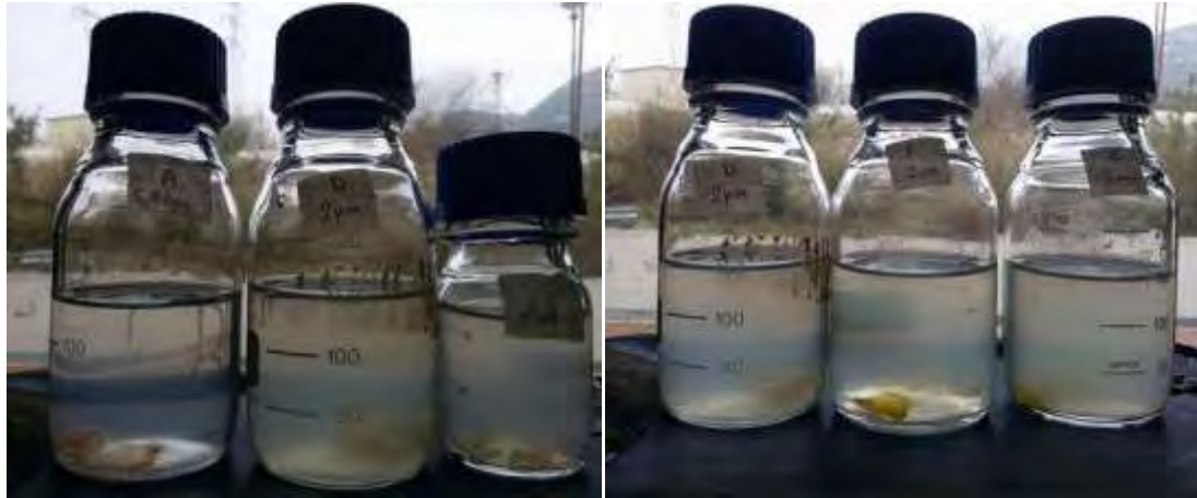
Εικόνες 4-5 : Μπουκάλια με θαλασσίνο νερό από φίλτρο διαμέτρου πόρου 0.1μm, 2 μm και τεχνητό θαλασσίνο νερό (NaCl).
