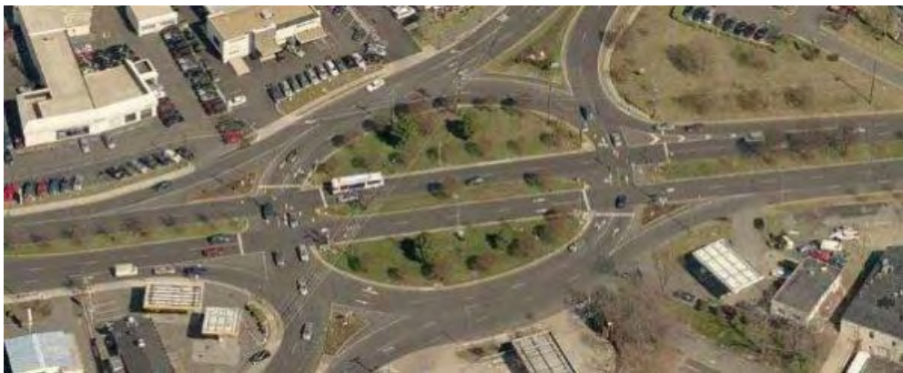
Εικόνα 2-20: Κυκλικός κόμβος μορφής hamburger στο Fairfax, Virginia
