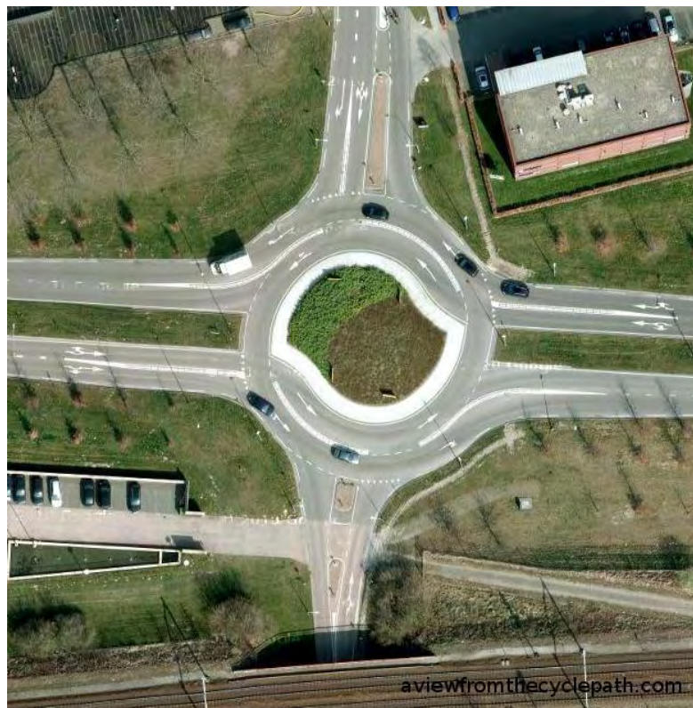
Εικόνα 2-21:Κυκλικός κόμβος μορφής turbo στην Ολλανδία
