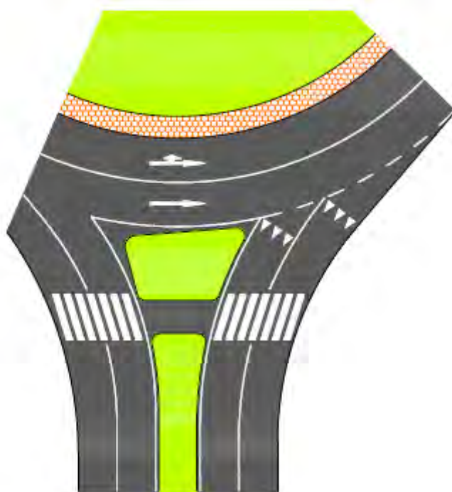
Εικόνα 4-35:Πεζοδιαβάσεις ευθυγραμμισμένες κάθετα στον άξονα του κλάδου
