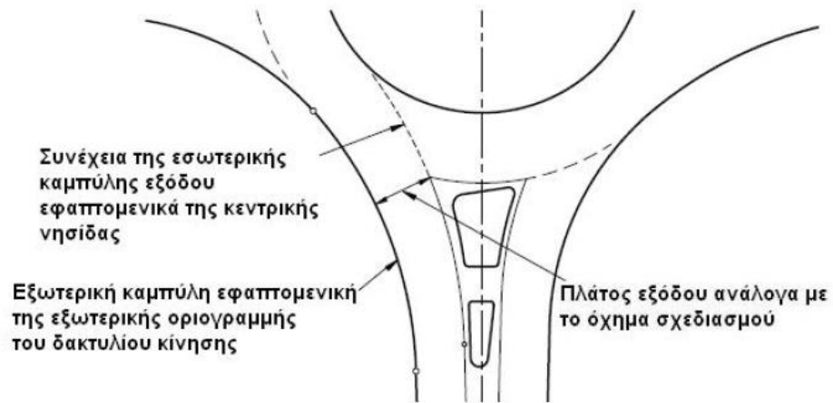
Εικόνα 4-18: Έξοδος με άξονα οδού διερχόμενο από το κέντρο του κόμβου
