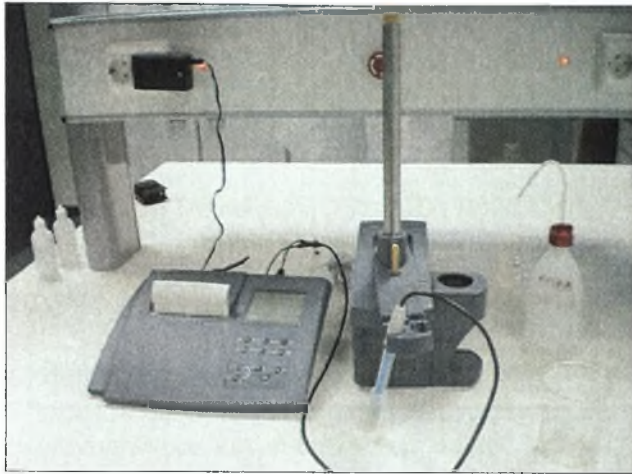
Εικόνα 13. Πεχάμετρο 730 inoLab WTW series που χρησιμοποιήθηκε για τις μετρήσεις (Σάββα 2010).
