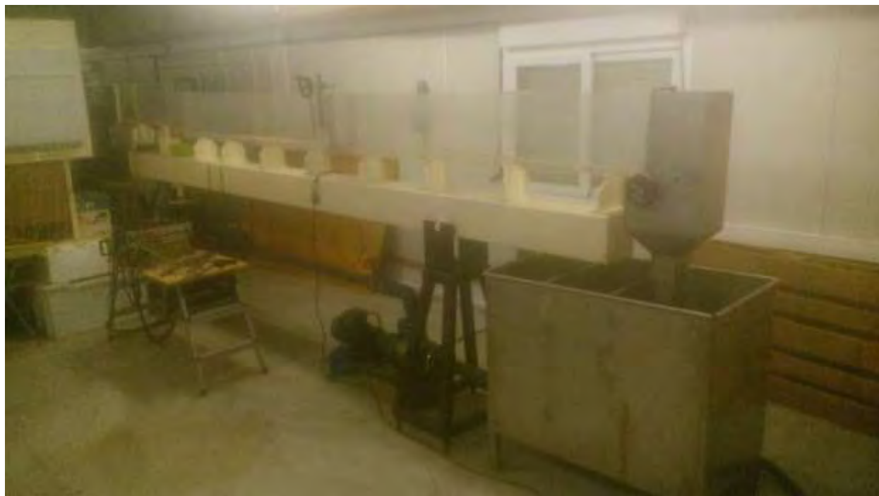
94. Προεγκατεστημένο πείραμα ανοιχτού αγωγού
