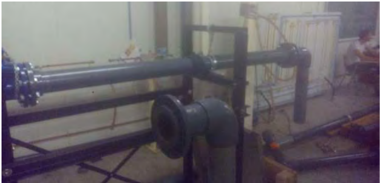
50. Σωλήνα συνδεδεμένη αριστερά με το παροχόμετρο, δεξιά με γωνία και στη μέση τοποθετημένο το μανόμετρο
