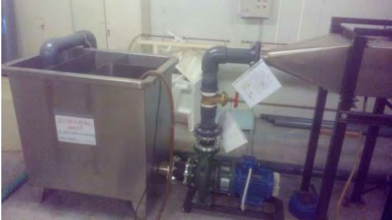
21. Το κομμάτι που κρατήσαμε: αντλία-μοτέρ-δεξαμενή- σωλήνα-θάνα-γωνία-φλάντζα
