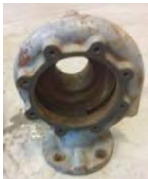
75. Χώρος κίνησης της πτερωτής στο εσωτερικό
