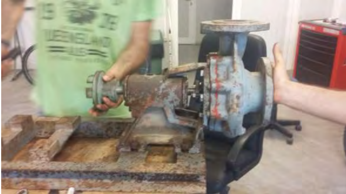
93. Ολοκληρωμένη η συναρμολόγηση της αντλίας
