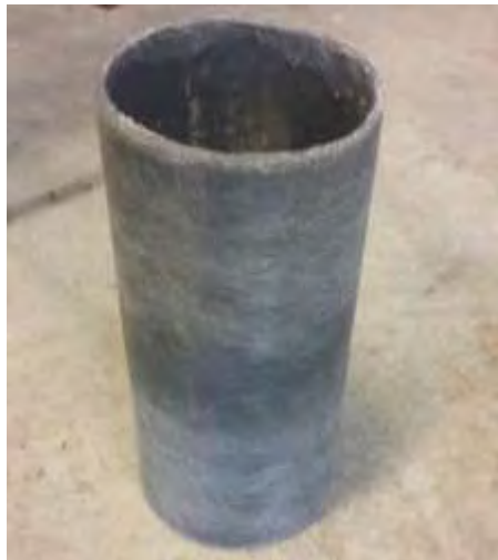
36. Έτοιμο κομμάτι σωλήνας για κόλληση
