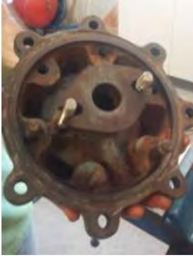
80. Στυπιοθλίπτης τοποθετημένος στην πλάτη του κελύφους
