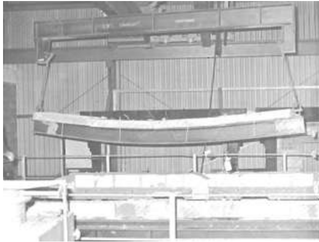
Εικόνα 19 Η μεταλλική δοκός του πειράματος τοποθετείται στον φούρνο (Wainman & Kirby, 1988, σ.32)
