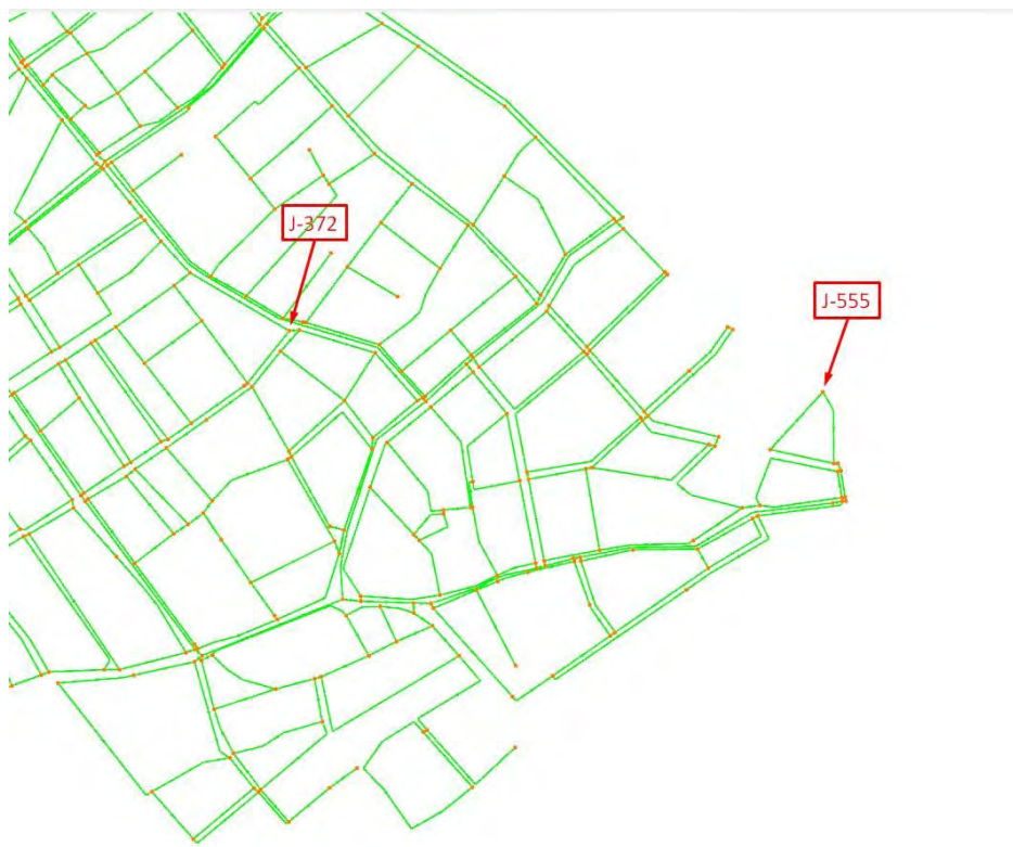
Εικόνα 5-9: Σενάριο 2 – 2 DMAs. Απεικόνιση κρίσιμων κόμβων J-372 και J-555
