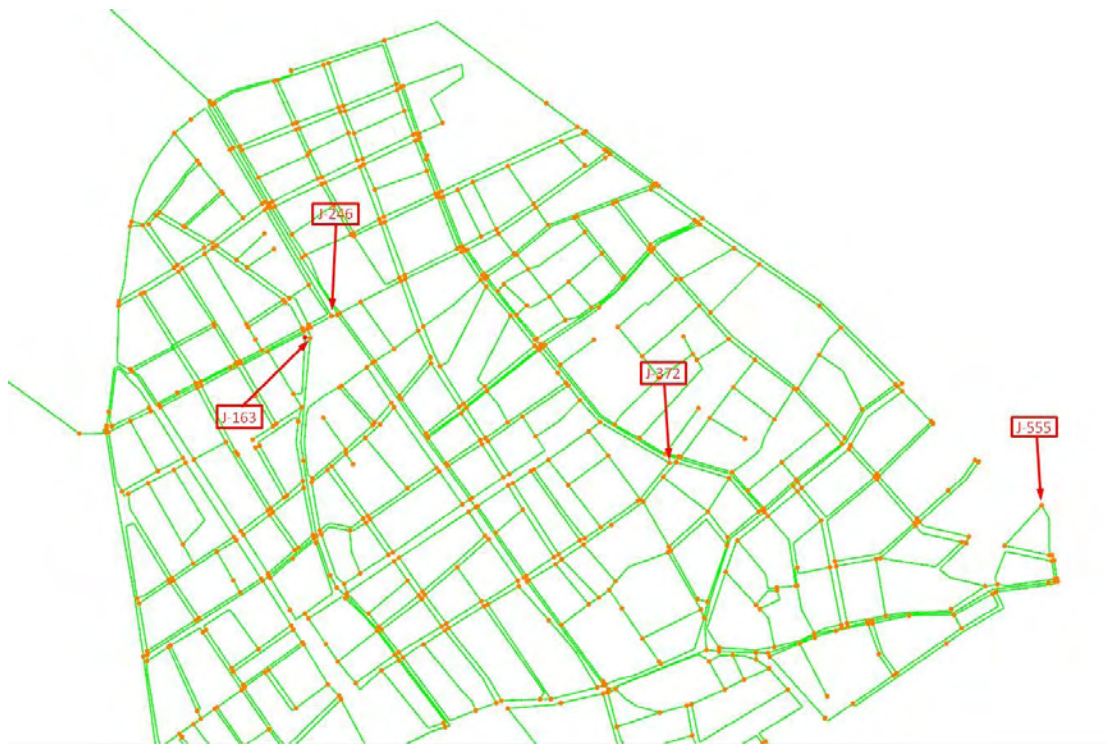
Εικόνα 5-15: Σενάριο 3 – 4 DMAs. Επισήμανση θέσης κρίσιμων κόμβων με βάση την πίεση, για κάθε DMA
