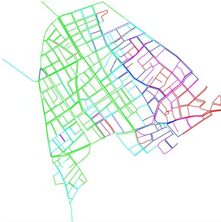
Εικόνα 5-11: Σενάριο 3 – 4 DMAs. Χρωματική απεικόνιση ηλικίας νερού
