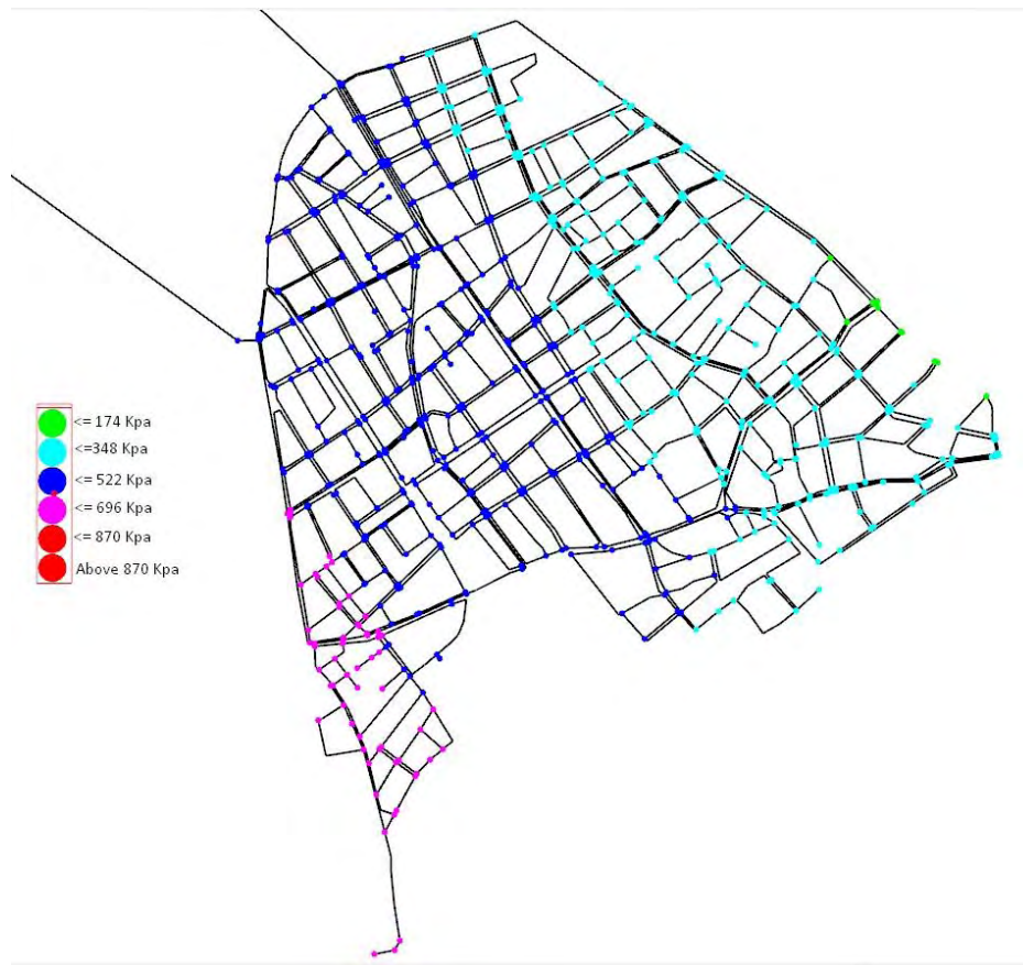
Εικόνα 5-2: Σενάριο 1 – No DMAs. Χρωματική απεικόνιση των κόμβων με βάση την πίεση
