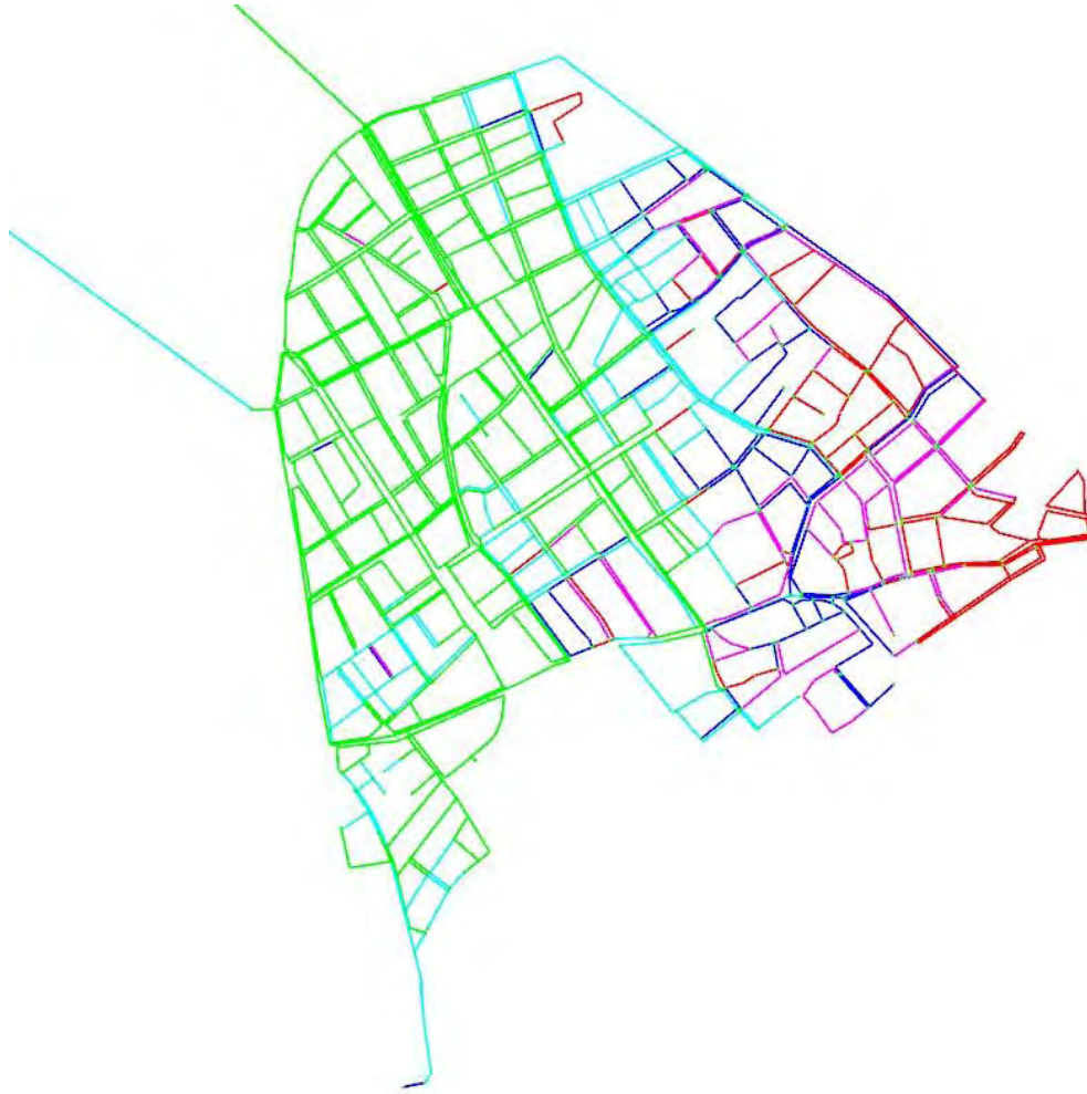
Εικόνα 5-3: Σενάριο 1 – No DMAs. Χρωματική απεικόνιση των αγωγών με βάση της ηλικία του νερού
