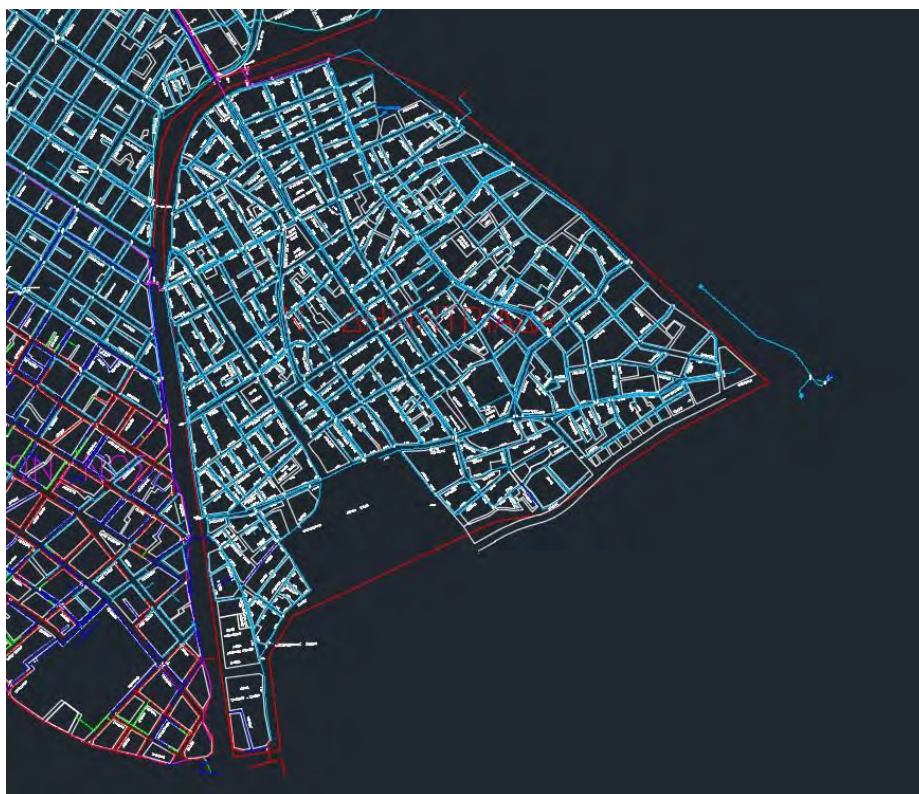
Εικόνα 4-6: Σχέδιο Δικτύου ύδρευσης Ν. Δημητριάδας σε περιβάλλον Autocad
