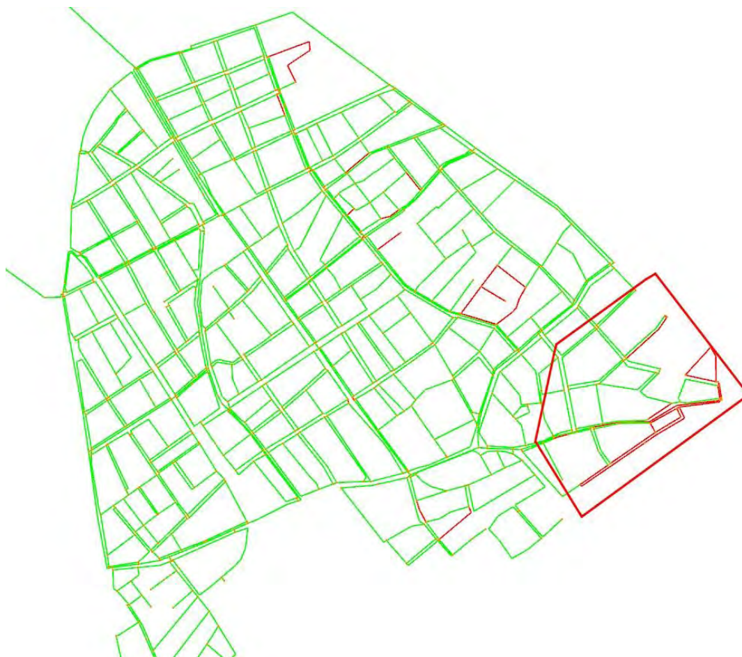
Εικόνα 5-10: Σενάριο 2 – 2 DMAs. Ανατολική περιοχή Νέας Δημητριάδας όπου συναντάται η μέγιστη ηλικία νερού. Εμφανώς βελτιωμένη η κατάσταση σε σχέση με την αρχική
