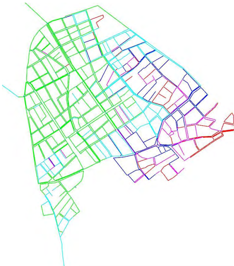
Εικόνα 5-6: Σενάριο 2 – 2 DMAs. Χρωματική απεικόνιση του δικτύου με βάση την ηλικία του νερού στους αγωγούς διανομής
