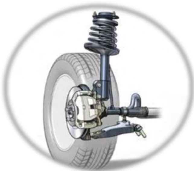
Σχήμα 1.1 : Παθητική ανάρτηση [36] Σχήμα 1.2 : Ημι-ενεργή ανάρτηση [36]
