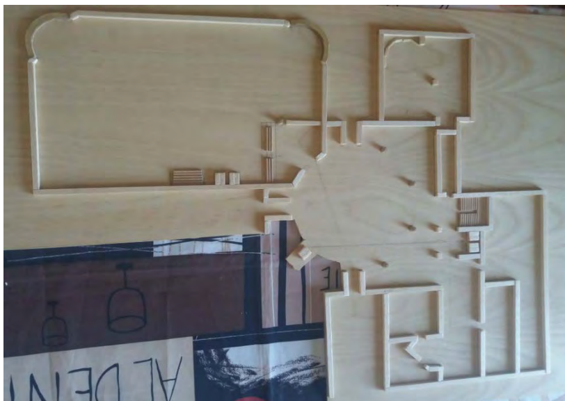
Εικόνα 5 - Συγκόλληση στοιχείων στη βάση
