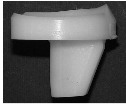
Εικ.10-4 Η παραμόρφωση του πρόσθιου πολυαιθυλενίου σε περίπτωση στερέωσης δια πίεσεως, σε σχήμα και σε φωτογραφία, να είναι ενδεικτική πρόσθιας οβελιαίας στρέψης του ενθέτου πολυαιθυλενίου.
