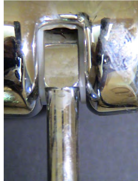
Εικ. 9-6 Μικρό εντύπωμα κυλίνδρου περιστροφής και μεγάλο εντύπωμα μηριαίου πολυαιθυλενίου (στη μηριαία εντομή).
