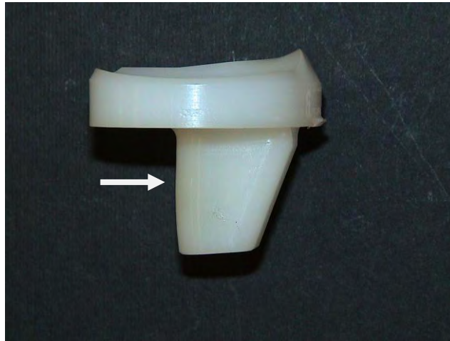
Εικ. 9-4 Μη προβλεπόμενη κύρτωση και κιτρινωπός αποχρωματισμός οπίσθιας επιφάνειας του στυλεού του πολυαιθυλενίου (βέλος).
