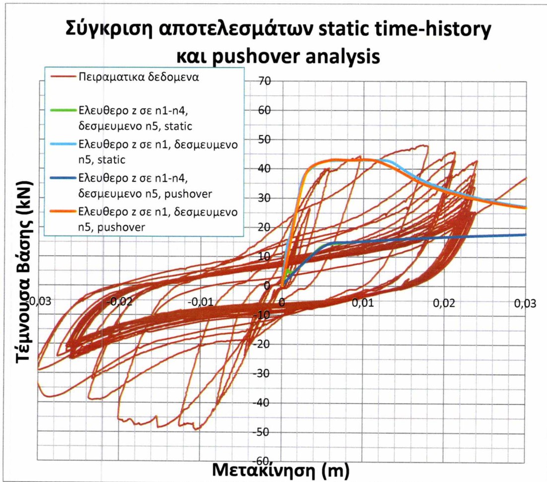
Σχήμα 3.12. Συγκριτικές καμπύλες διατμητικής δύναμης – πλευρικής μετατόπισης του ενισχυμένου πλαισίου με Χ-συνδέσμους L20x3.
