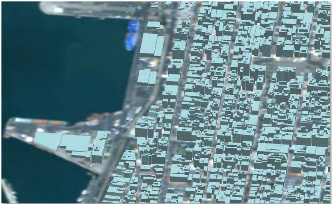
Εικόνα 29. Στερεοσκοπική απόδοση όγκου κτισμάτων για τον Δήμο Πατρέων με χρήση δορυφορικών εικόνων υψηλής ανάλυσης GeoEye-1 (MaP ΕΠΕ, 2006).
