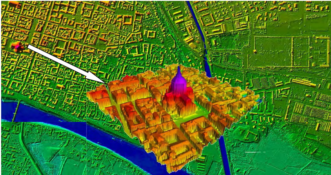
Εικόνα 36. Παράδειγμα εφαρμογής της τεχνολογίας LIDAR σε 3D μοντέλο τμήματος της ιταλικής πόλης Πάβια (Γεωργόπουλος, 2015).
