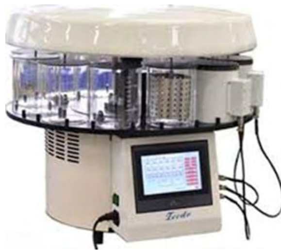
Εικόνα 2: Μηχάνημα διαδοχικής εμβάπτισης ιστών σε αλκοόλες (Πηγή : PST)
