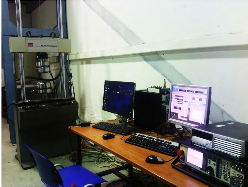
Εικόνα 4-2: Διάταξη της μηχανής εφελκυσμού MTS του Εργαστηρίου Μηχανικής και Αντοχής των Υλικών
