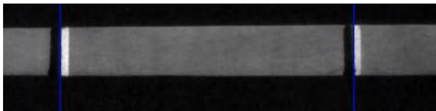
Εικόνα 4-3: Απόσταση μεταξύ δύο σημείων όπως αναγνωρίζονται μέσω του λογισμικού του οπτικού συστήματος
