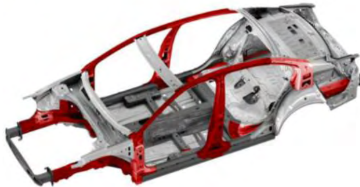
Εικόνα 3-1: Σημεία του αμαξώματος όπου χρησιμοποιείται χάλυβας TRIP
