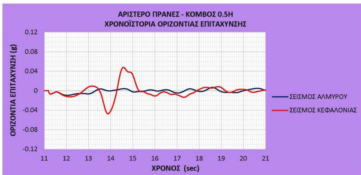
Διάγραμμα 5.3.3.7. Χρονοϊστορία οριζόντιας επιτάχυνσης σε σημείο ύψους 0.5H (54.5m) του αριστερού αντερείσματος της κεντρικής διατομής του φράγματος κατά τη δυναμική φόρτιση του συστήματος.
