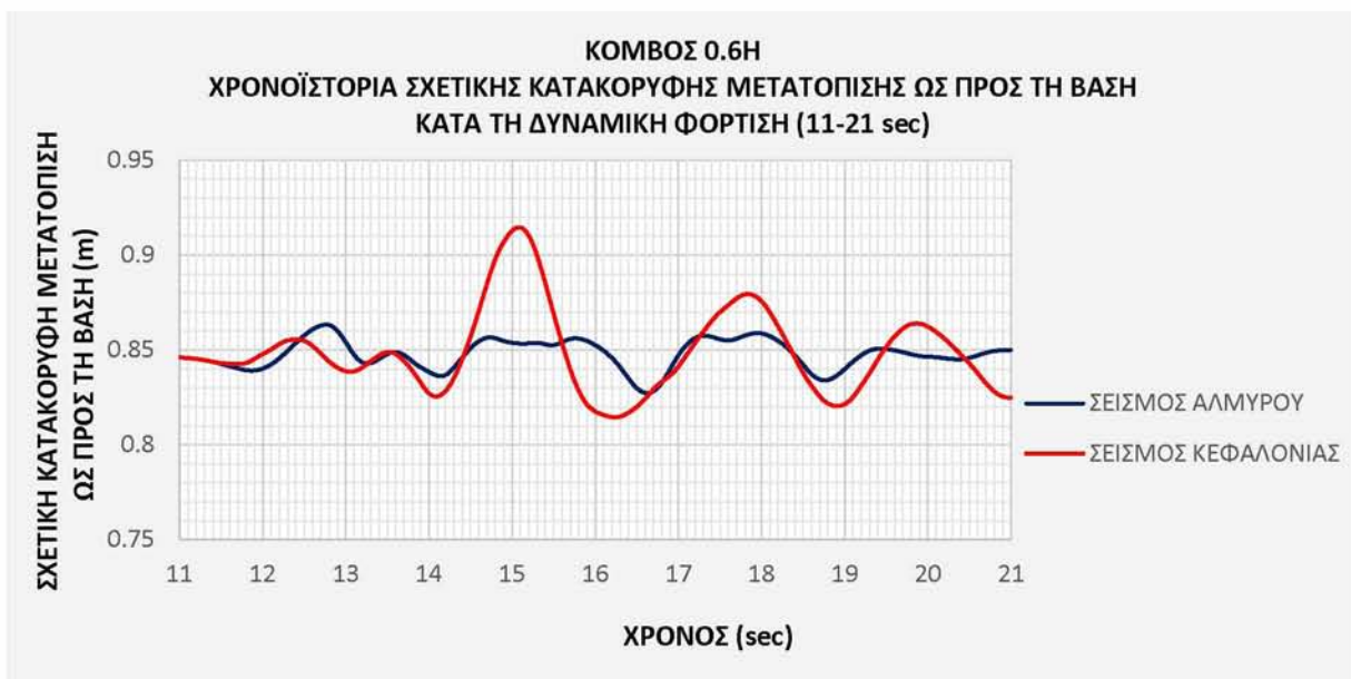
Διάγραμμα 5.3.2.3. Χρονοϊστορία σχετικής κατακόρυφης μετατόπισης ως προς τη βάση του φράγματος σε σημείο ύψους 0.6H (65.4m) της κεντρικής διατομής του φράγματος κατά τη δυναμική φόρτιση του συστήματος.
