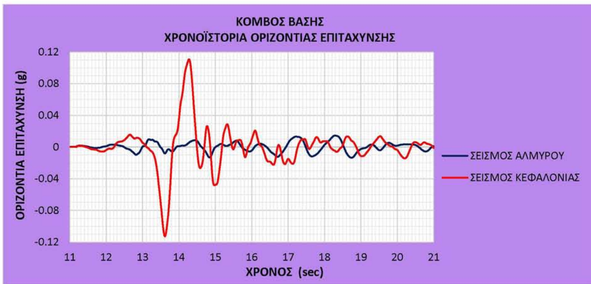
Διάγραμμα 5.3.3.6. Χρονοϊστορία οριζόντιας επιτάχυνσης στο κέντρο της βάσης της κεντρικής διατομής του φράγματος κατά τη δυναμική φόρτιση του συστήματος.
