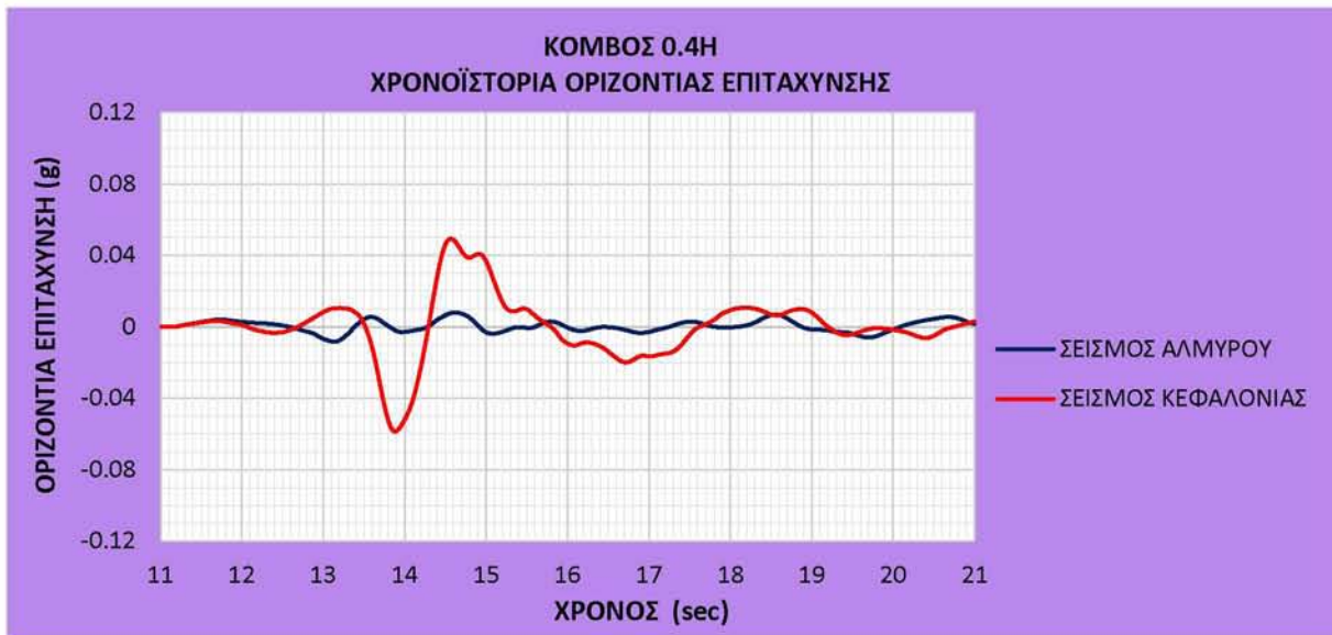
Διάγραμμα 5.3.3.2. Χρονοϊστορία οριζόντιας επιτάχυνσης σε σημείο ύψους 0.4H (43.6m) της κεντρικής διατομής του φράγματος κατά τη δυναμική φόρτιση του συστήματος.
