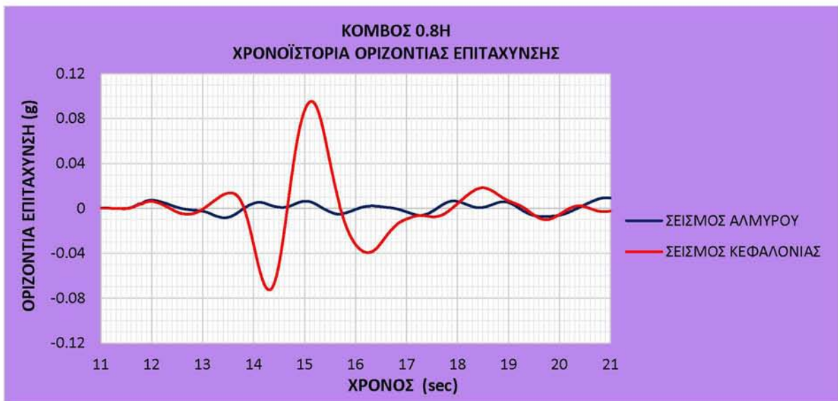
Διάγραμμα 5.3.3.4. Χρονοϊστορία οριζόντιας επιτάχυνσης σε σημείο ύψους 0.8H (87.2m) της κεντρικής διατομής του φράγματος κατά τη δυναμική φόρτιση του συστήματος.
