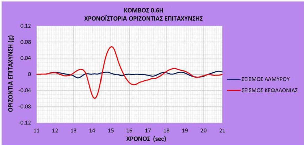
Διάγραμμα 5.3.3.3. Χρονοϊστορία οριζόντιας επιτάχυνσης σε σημείο ύψους 0.6H (65.4m) της κεντρικής διατομής του φράγματος κατά τη δυναμική φόρτιση του συστήματος.
