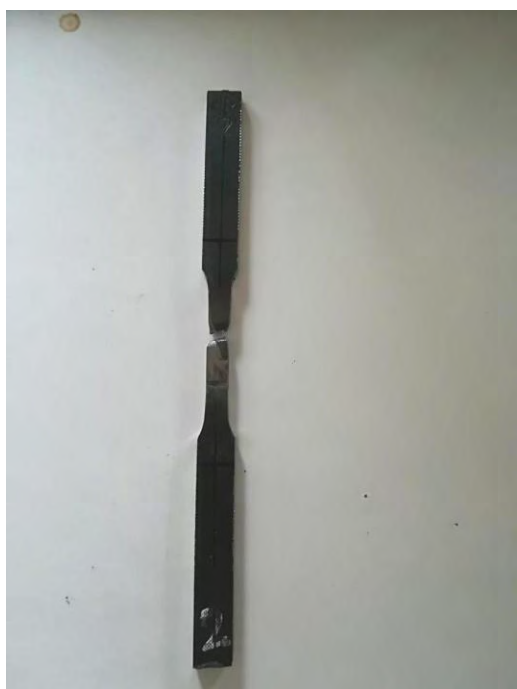
Εικόνα 4.49 Δοκίμιο 5_A, θέση θραύσης στο βασικό μέταλλο
