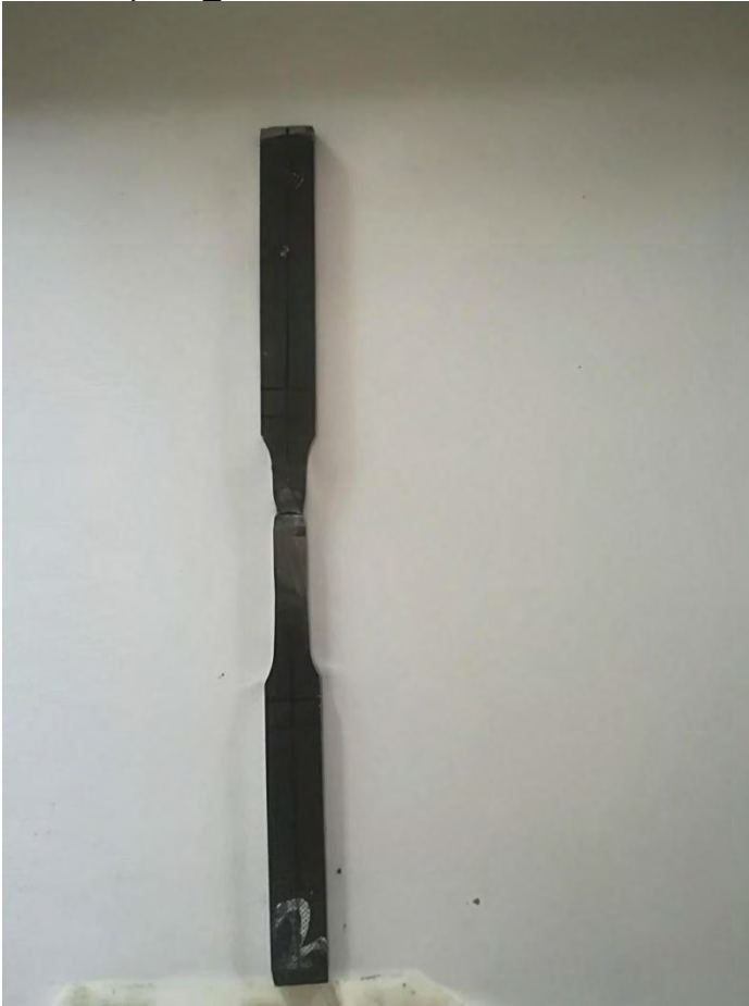
Εικόνα 4.50 Δοκίμιο 5_B, θέση θραύσης στο βασικό μέταλλο
