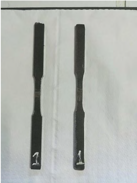
Εικόνα 3.3 Δοκίμια εφελκυσμού από το δείγμα 4
