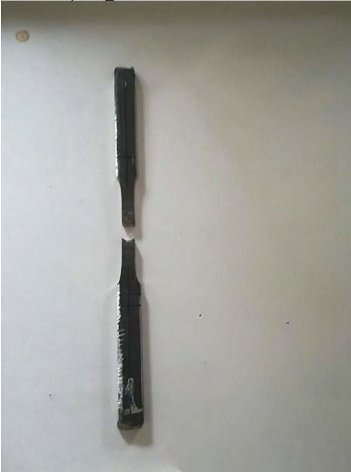
Εικόνα 4.48 Δοκίμιο 4_B, θέση θραύσης στη ΘΕΖ
