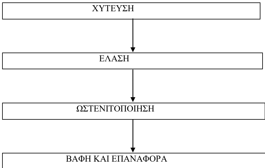
Διάγραμμα 2.1 Θερμικές κατεργασίες για την παραγωγή Armox 500T
