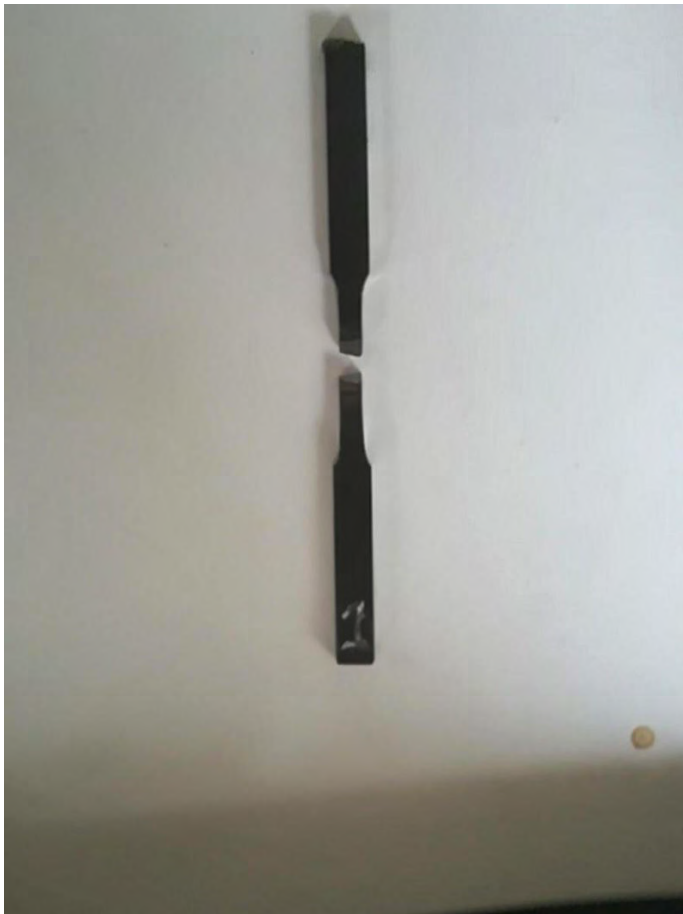
Εικόνα 4.47 Δοκίμιο 4_A, θέση θραύσης στη ΘΕΖ
