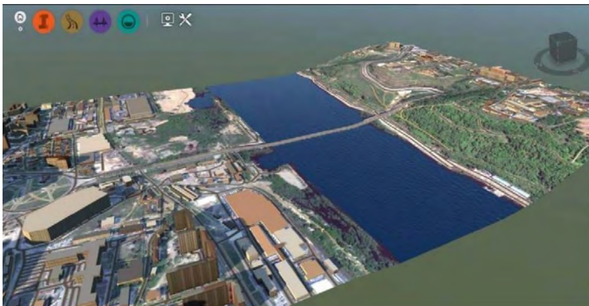
Εικόνα 1: Αυτοματοποιημένο 3D ψηφιακό μοντέλο εδάφους και κυκλοφοριακής κατάστασης μέσω του earthexplorer.usgs.gov (Πηγή: M. Eliseev, 2016)
