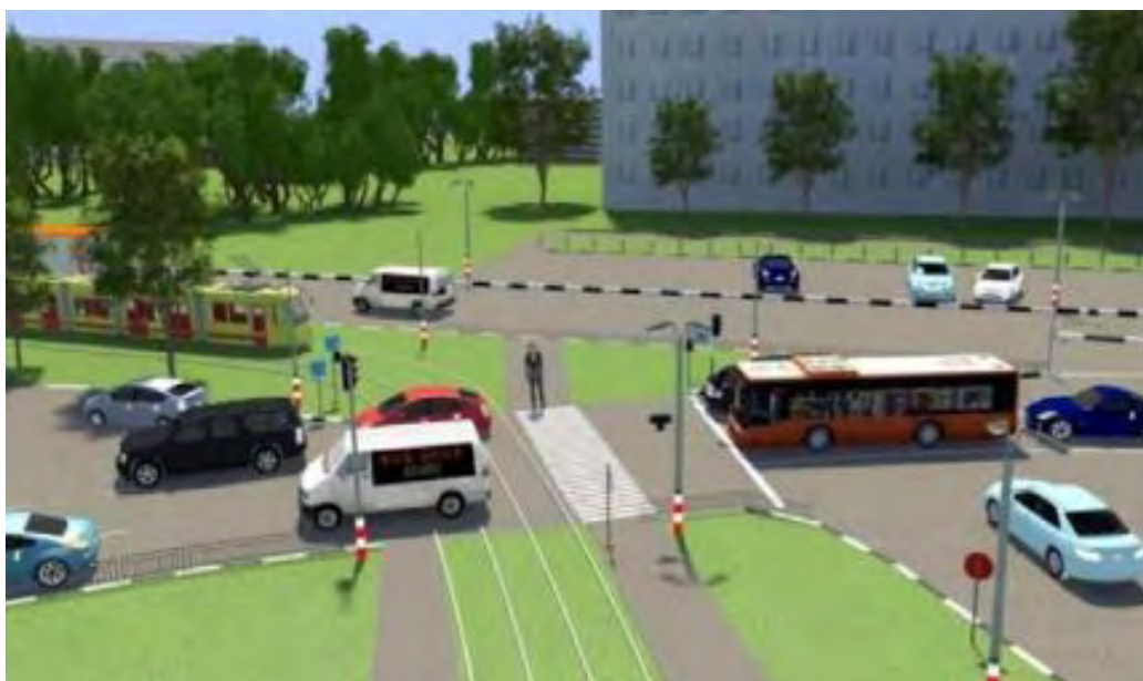
Εικόνα 5: Τροποποίηση της κυκλοφοριακής υποδομής: προσθήκη σήματος διέλευσης πεζών (Πηγή: M. Eliseev, 2016)
