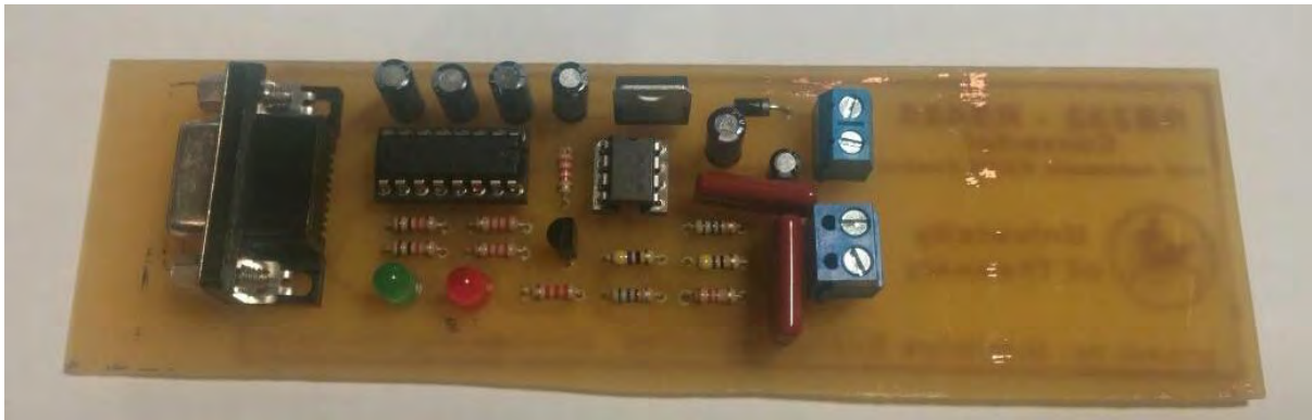
Σχήμα 4.1.13 - Τελική κατασκευή με τοποθετημένα ηλεκτρονικά στοιχεία. Επάνω όψη
