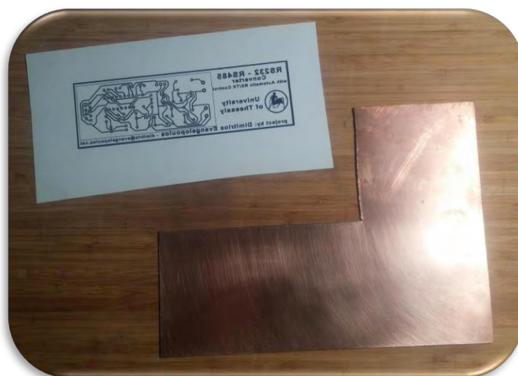
Σχήμα 4.1.9 - Τυπωμένα traces πάνω σε γυαλιστερό χαρτί και επιχαλκωμένη πλακέτα
