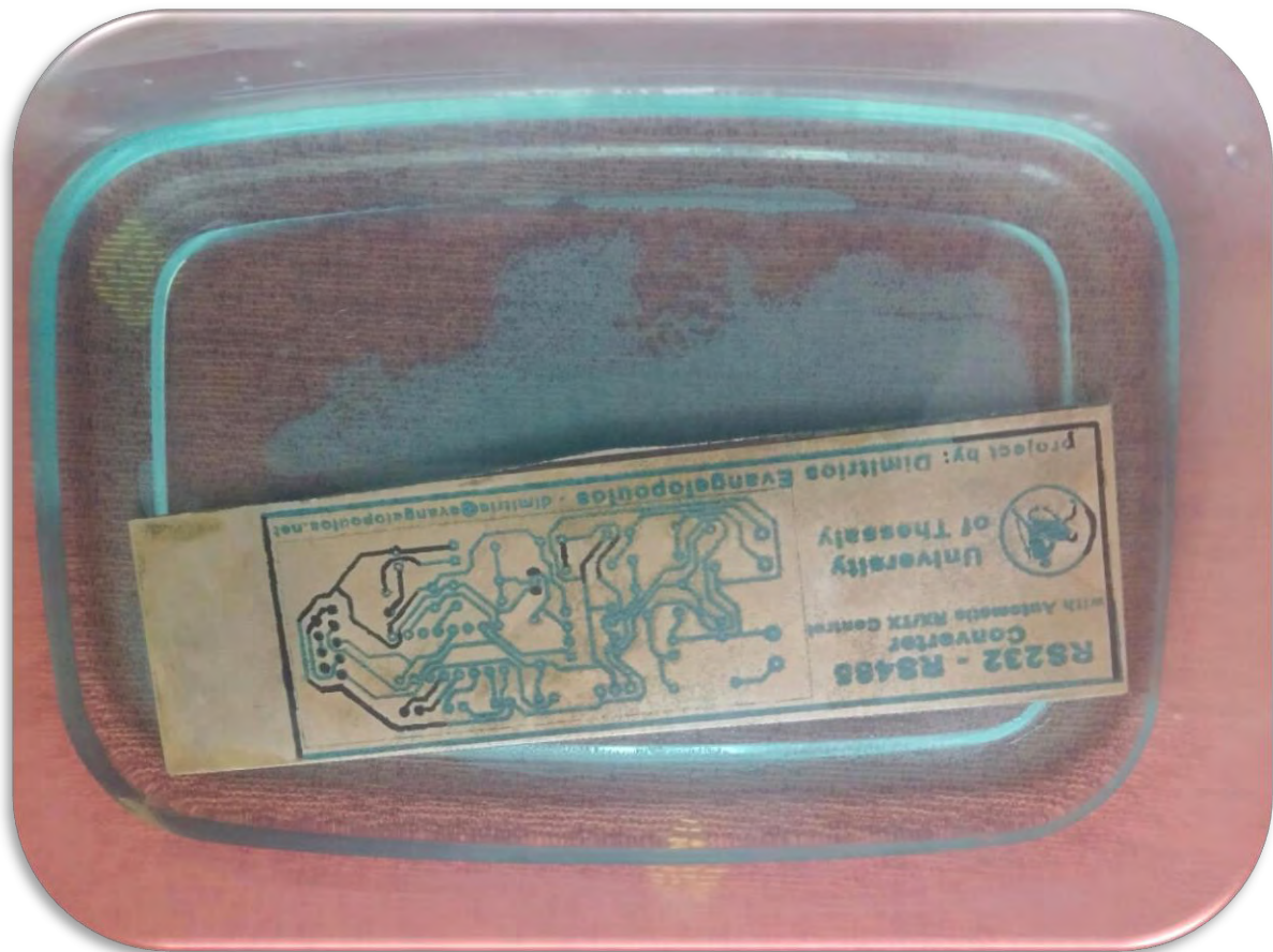
Σχήμα 4.1.10 - Διαδικασία αποχάλκωσης πλακέτας
