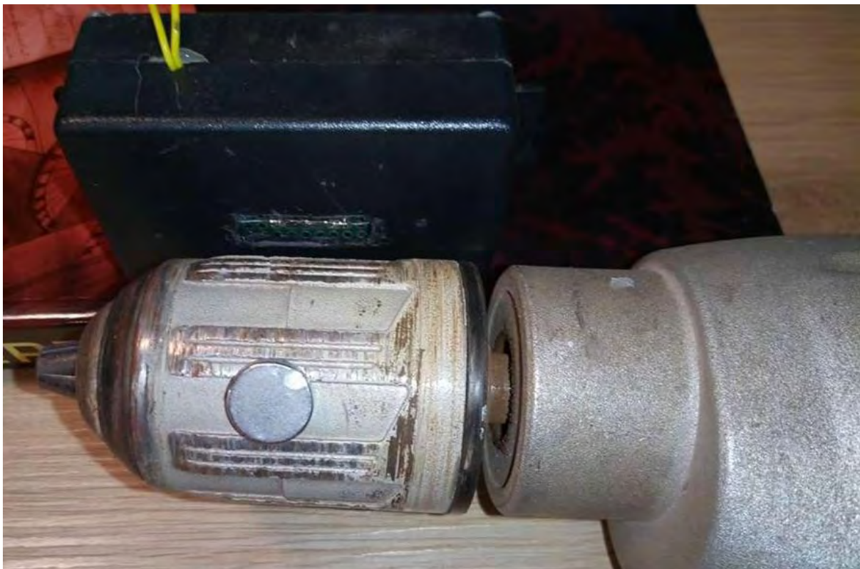
Σχήμα 3.3.6 - Μαγνήτης ενσωματωμένος σε δράπανο, δίπλα από το Reed switch(μέσα στο μαύρο κουτί)
