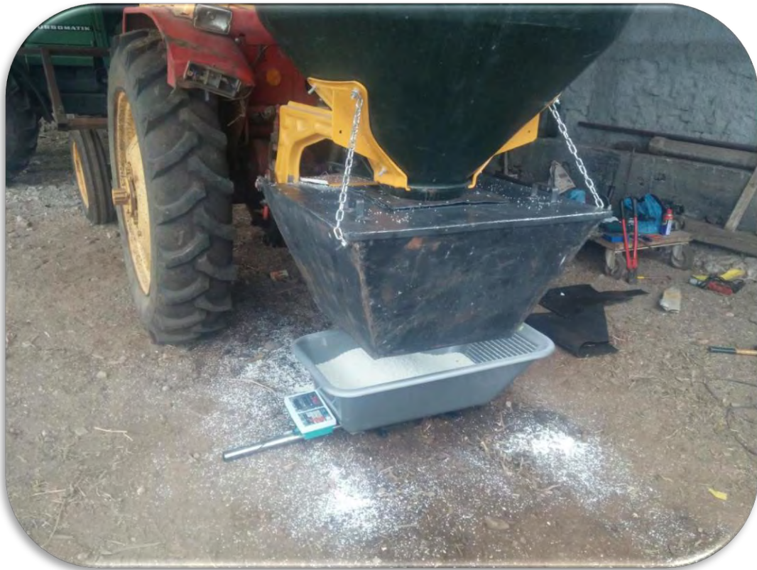
Σχήμα 4.1.41 – Η διαδικασία της βαθμονόμησης σε εξέλιξη
