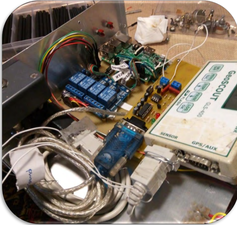
Σχήμα 4.3.4 - ασφάλιση καλωδίων με δετικά και σύρμα ώστε να παραμείνουν στη θέση τους και να αποφευχθεί μια ενδεχόμενη αποσύνδεση λόγω κραδασμών
