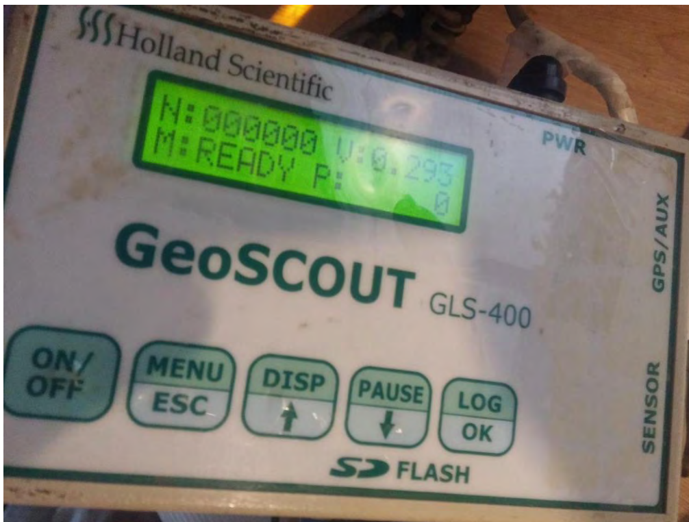
Σχήμα 4.1.16 - Η αντίστοιχη τιμή που εμφανιζόταν στην LCD του data logger (η μικρή απόκλιση εμφανίζεται γιατί οι φωτογραφίες δεν έχουν ληφθεί για το ίδιο πακέτο δεδομένων).
