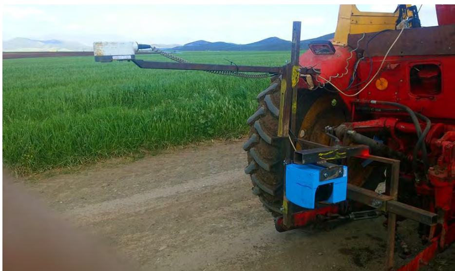
Σχήμα 3.3.2 - Η θέση των αισθητήρων (Crop-Circle) [10], να είναι στο πίσω μέρος του γεωργικού ελκυστήρα, κάτι το οποίο αργότερα αποδείχθηκε προβληματικό, καθώς η διασπορά του λιπάσματος, "εμπόδιζε", την ακριβή μέτρηση του αισθητήρα.
