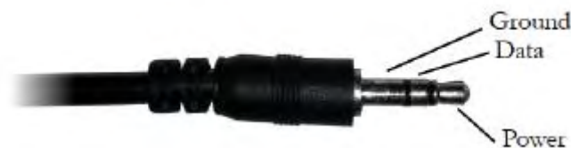
Σχήμα 4.1.18 - Διασύνδεση αισθητήρων στο sdi bus [49]
