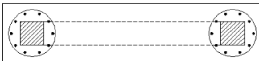
Σχήμα 2- 5:Εμφάντωση πάχους μεγαλύτερου του πλάτους της δοκού (Δρίτσος, 2003)
