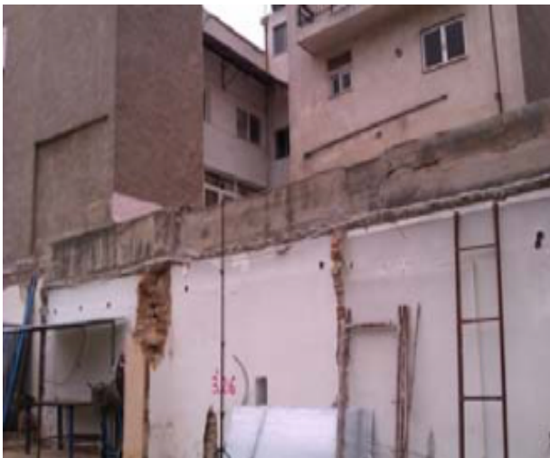
ΕΙΚΟΝΑ 22 Εργοτάξιο «ΜΑΝΙΑΤΙΚΑ»- ΑΥΤΟΝΟΜΟΣ ΚΙΝΗΤΟΣ ΣΤΑΘΜΟΣ ΘΟΡΥΒΟΥ ΜΕ ΣΤΑΤΙΣΤΙΚΟ ΑΝΑΛΥΤΗ ΚΑΙ ΔΙΑΤΑΞΗ ΠΑΝΤΟΣ ΚΑΙΡΟΥ (ΣΕ ΕΙΔΙΚΟ ΙΣΤΟ) ΤΥΠΟΥ
