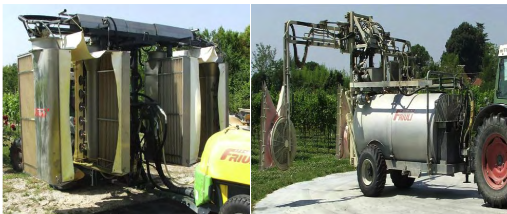
Εικόνα 23: Σύγκριση διαμόρφωσης ψεκαστήρα που απορροφά την περίσσια ψεκαστικού διαλύματος εκτός στόχου (αριστερά) σε σχέση με έναν συμβατικό (δεξιά) (Pergher et al., 2013).
