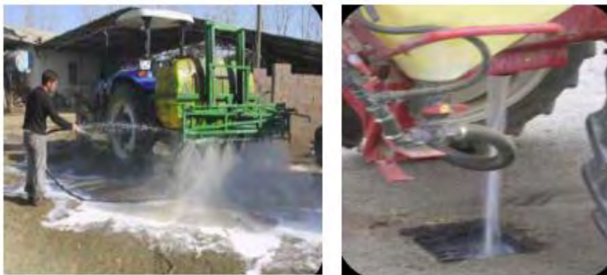
Εικόνα 8: Ακατάλληλη διαδικασία καθαρισμού δεξαμενής ψεκαστικού συγκροτήματος (Μπουροδής, 2014).
