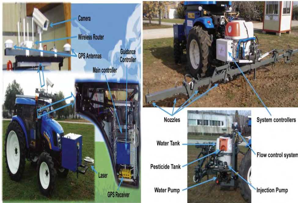
Εικόνα 22: Πλήρως αυτόματοποιημένο σύστημα ψεκασμού με αυτοκινούμενο γεωργικό ελκυστήρα που σκανάρει την περιοχή με την χρήση κάμερας για την παρουσία ζιζανίων και με την χρήση βαλβίδων και αισθητήρων ενεργοποιεί τα ακροφύσια ψεκασμού (Gonzalez-de-Soto et al., 2016)).
