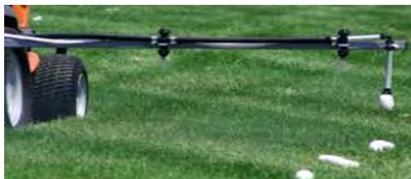
Εικόνα 28: Σήμανση ψεκασμένων περιοχών με την χρήση αφρού.
