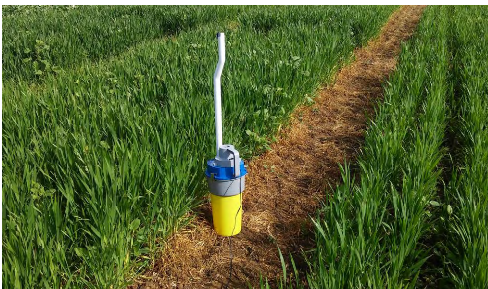
Εικόνα 4. Αυτοσχέδια παγίδα εναερίου μολύσματος.
