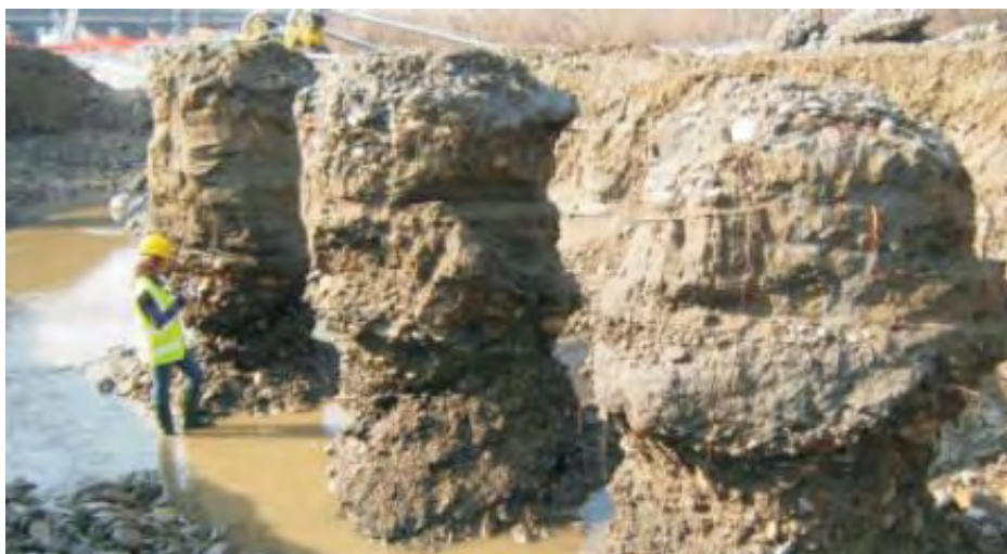
Σχήμα 4.8: Επιτόπου παρατηρήσεις της διαμέτρου των πασσάλων στο πεδίο
