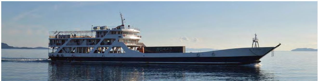
Εικόνα 26 Κλασσικό ΕΓ/ΟΓ ανοιχτού τύπου ελληνικής κατασκευής.
