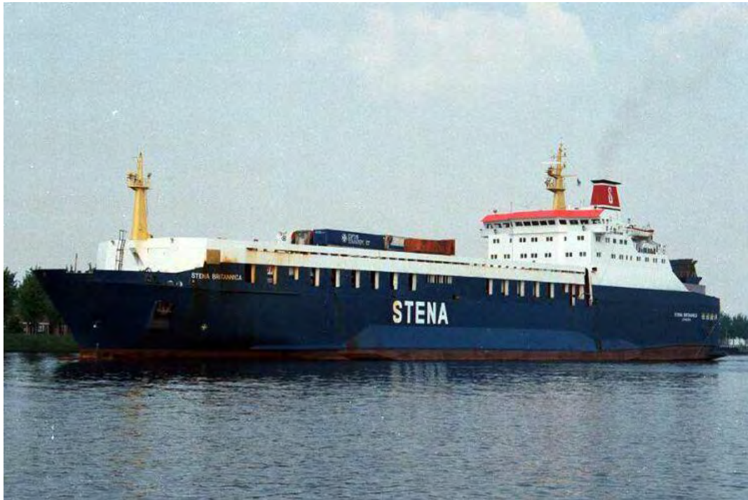
Εικόνα 19 Το STENA BRITANNICA (πρώην ATLANTIC PROJECT) με την τελική του μορφή μετά την προσθήκη ενός deck καθ' ύψος. Πηγή εικόνας: faktaomfartyg.se
