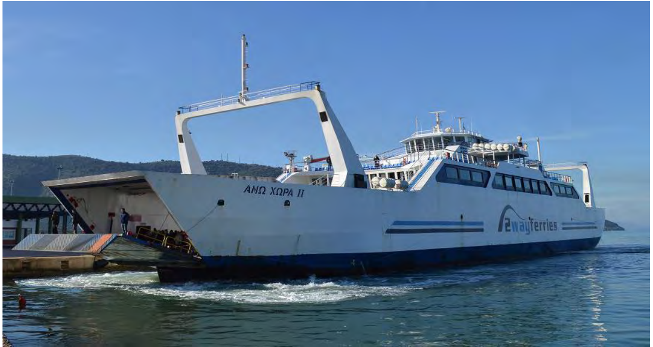
Εικόνα 24 Τυπικό αμφίπλωρο ΕΓ/ΟΓ ανοιχτού τύπου Ελληνικής κατασκευής.
