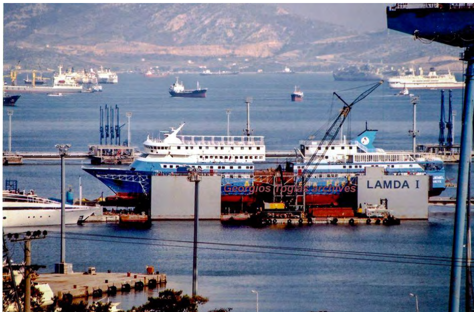
Εικόνα 17 Η επιμήκυνση του AQUA JEWEL στα ναυπηγεία ΛΑΜΔΑ στην Ελευσίνα. Φωτογραφία του κυρίου Γιώργου Τόγια.
