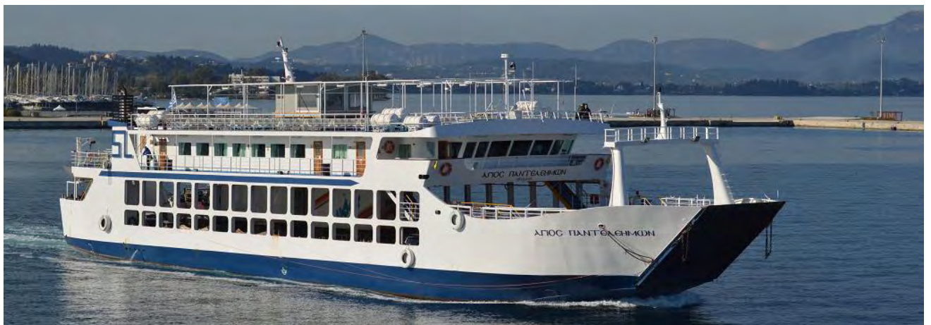
Εικόνα 25 ΕΓ/ΟΓ ανοιχτού τύπου Ελληνικής κατασκευής, με πιο σύγχρονα σχεδιαστικά στοιχεία. Σχεδόν παντού το γκαράζ είναι "καλυμμενο", ώστε να υπάρχει περισσότερος χώρος για επιβάτες επάνω, ωστόσο παραμένει ανοιχτο ferry.
