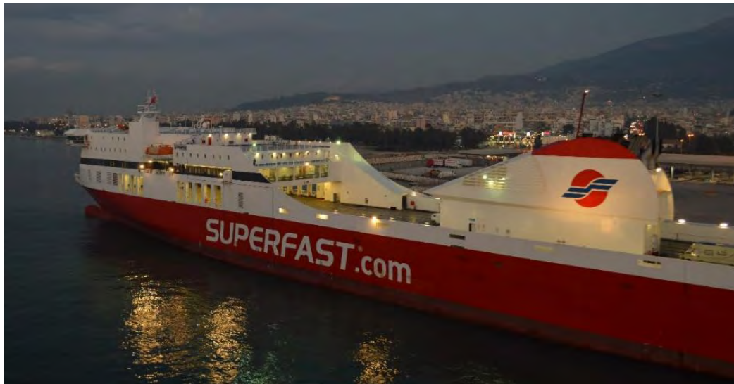
Εικόνα 20 Τυπικό Ro-Rach. Εκτελεί πλόες σε διεθνή γραμμή Ελλάδας (Πάτρα) - Ιταλίας (Bari), όπου δίνεται έμφαση στα φορτηγά διεθνών μεταφορών. Διακρίνεται το ανοιχτό γκαράζ για φόρτωση φορτηγών με επικίνδυνα φορτία.
