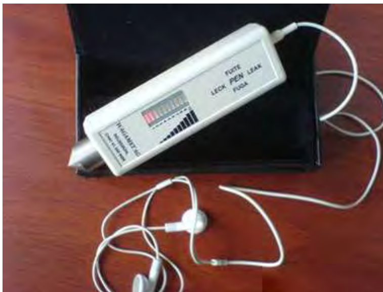
Εικόνα 7- 5: Συσκευές εντοπισμού των διαρροών – γεώφωνο
