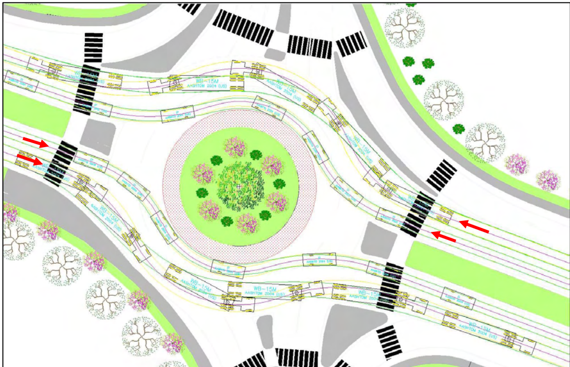
Διάγραμμα 8.7.4 – 1 Κίνηση Ανατολή – Δύση και Δύση Ανατολή του οχήματος σχεδιασμού (WB-15) παράλληλα με Ι.Χ. (μεγάλος κυκλικός κόμβος)
