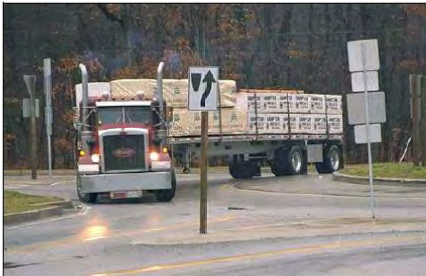
Εικόνα 3.3.4-1 Παράδειγμα κυκλικού κόμβου σχεδιασμένου για μεγάλα φορτηγά (National Cooperative Highway Research Program, 2010)
