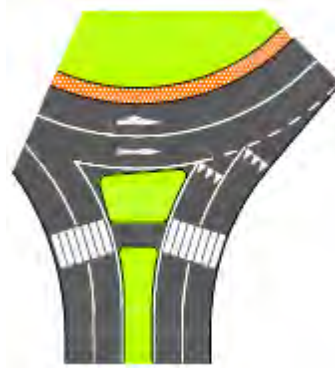
Σχήμα 3.4.1-1 Πεζοδιαβάσεις κάθετες στις οριογραμμές των κλάδων εισόδου και ευθυγραμμισμένες με τη ροή της κυκλοφορίας (προτιμώμενη διάταξη) (ΟΜΟΕ Κ 3 , 2011)
