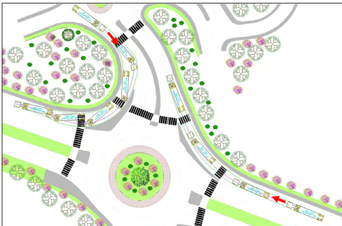
Διάγραμμα 8.7.4 – 3 Κίνηση Ανατολή – Βορράς και Βορράς - Δύση του οχήματος σχεδιασμού (WB-15) (μεγάλος κυκλικός κόμβος)
