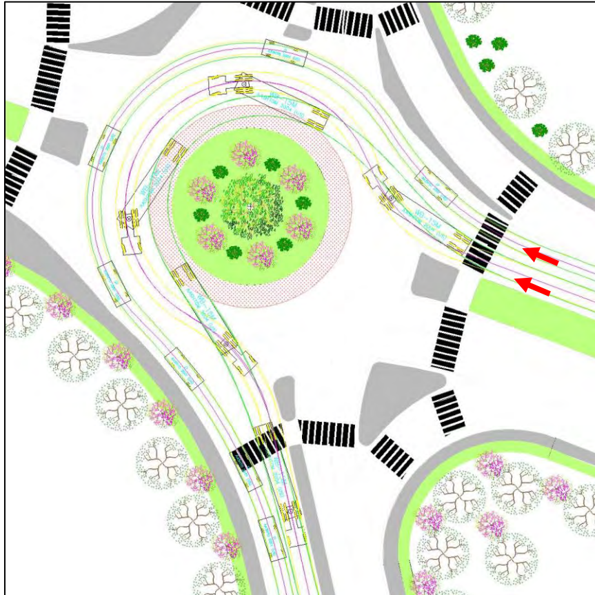
Διάγραμμα 8.7.4 – 2 Κίνηση Ανατολή – Νότος του οχήματος σχεδιασμού (WB-15) παράλληλα με Ι.Χ. (μεγάλος κυκλικός κόμβος)
