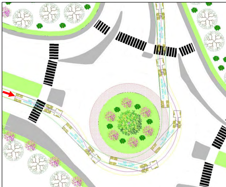
Διάγραμμα 8.7.4 – 4 Κίνηση Δύση – Βορράς του οχήματος σχεδιασμού (WB-15) (μεγάλος κυκλικός κόμβος)
