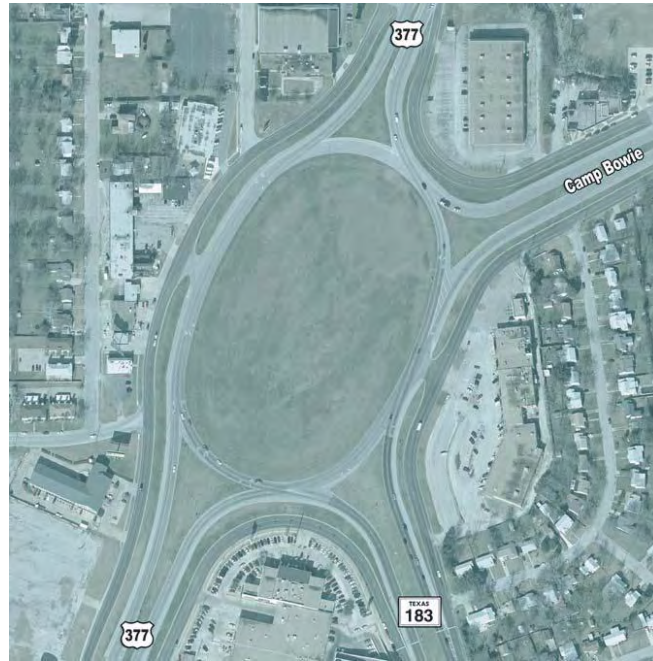
Εικόνα 1.1.1-3 Παράδειγμα περιστροφικής κυκλικής κίνησης (Rotary) (NCHRP & FHWA, 2010)
