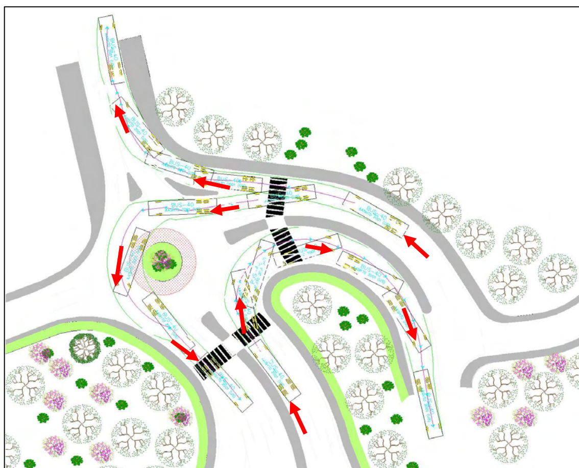
Διάγραμμα 8.7.4 – 7 Δυσχερέστερες κινήσεις του οχήματος σχεδιασμού (BUS-40) στο κομβίδιο
