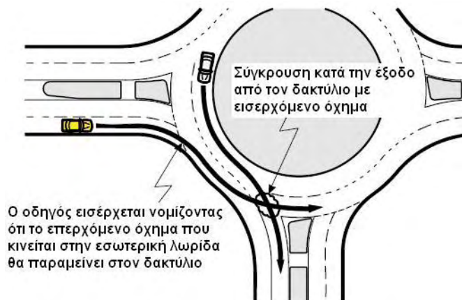
Σχήμα 6.3-2 Συγκρούσεις κατά την έξοδο λόγω λάθους στην επιλογή λωρίδας του κινούμενου επί του δακτυλίου
