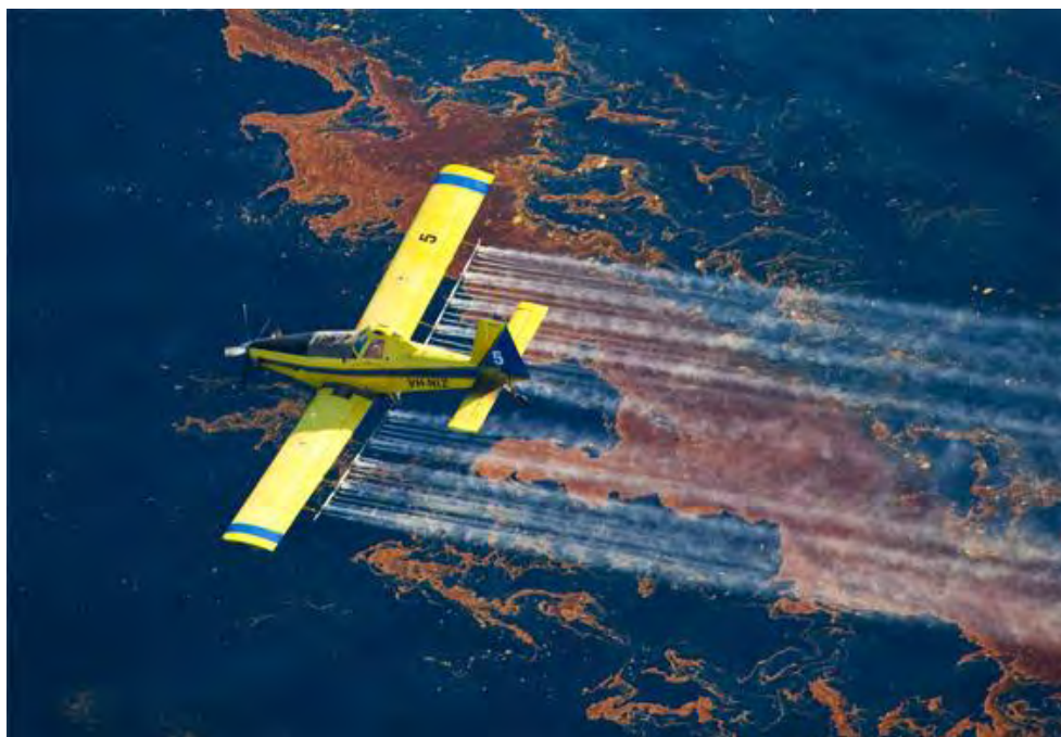
Εικόνα 33: χημικός ψεκάσμος πετρελαιοκηλίδας από αεροπλάνο
