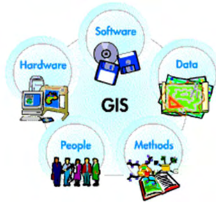
Εικόνα 5.4: Δομή ενός ΓΣΠ (Πηγή: http://www.rst2.edu/ )
