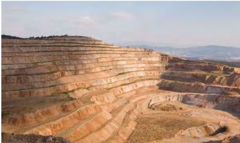
Εικόνα 2.4 Χαρακτηριστική εικόνα εκμετάλλευσης λατομείου αδρανών υλικών – Βαθμίδες λατομείου αδρανών υλικών Χάλυψ Δομικά Υλικά Α.Ε. (Πηγή: www.orykta.gr )
