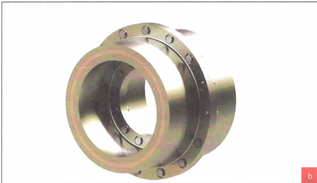
Εικόνα 58: Σχέδιο σύνδεσης μετωπικής φλάντζας (a) σε κατάσταση λειτουργίας του δοχείου, (b) πλήρως αποσυναρμολογημένο.
