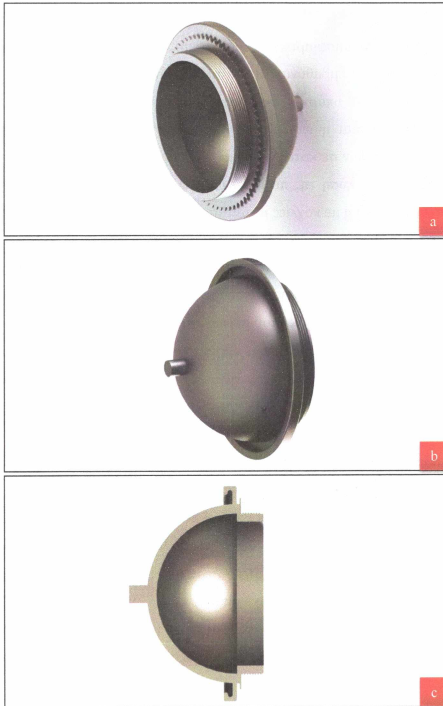
Εικόνα 45: Απεικόνιση του ημισφαιρικού άκρου του δοχείου πίεσης, (a) εσωτερικά, (b) εξωτερικά, (c) τομή πλάγιας όψης.
