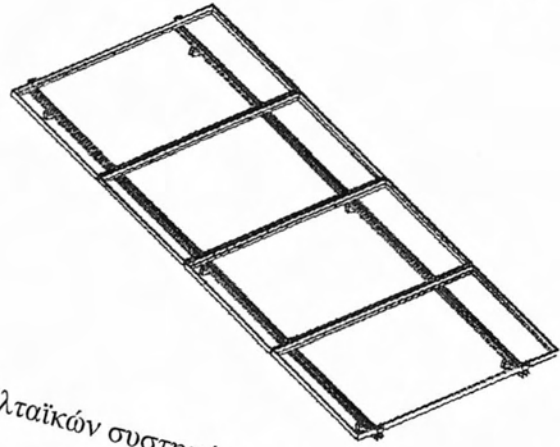
Σχήμα 1.3 Τυπικό μεταλλικό σύστημα για στήριξη φωτοβολταϊκών συστημάτων σε στέγη με πάνελ.
