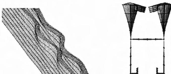
Σχήμα 5.7 Μορφή γεωμετρικής ατέλειας λυγισμού.
