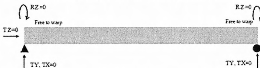
Σχήμα 5.20 Συνθήκες στήριξης απλά εδραζόμενης δοκού (free to warp).
