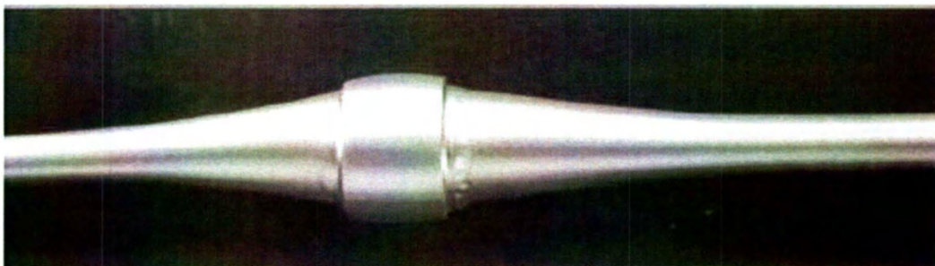
Σχήμα 67 Παραμορφωμένος αναστολέας μετά από πείραμα (Kyriakides,S και Park T.D. On the performance of integral Buckle arrestors for offshore pipelines )
