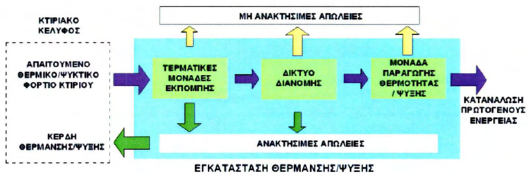
Εικόνα 8 Γενικό διάγραμμα υπολογισμών θέρμανσης/ ψύξης
