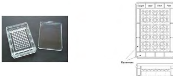
Εικόνα 15: Τριβλίο Κρυσταλλώσεων 96 θέσεων τύπου microbatch plate VBATC-1/1-PHO-10 της εταιρείας Douglas Instrumets
