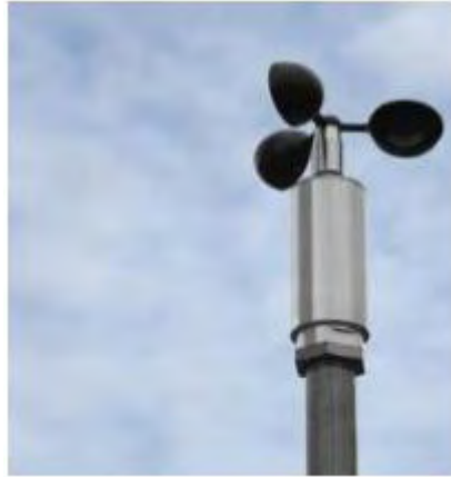
Σχήμα 2.16 Ανεμόμετρα, α) ανεμόμετρο με μέτρηση ταχύτητας στον άξονα β) ανεμόμετρο Sonic με μετρητή θερμικής ενέργειας [4].
