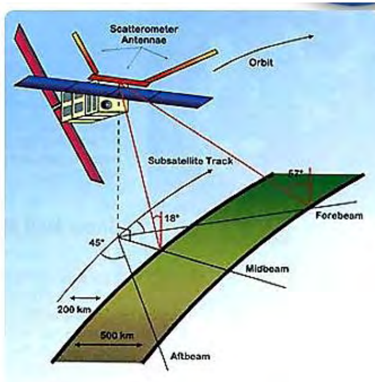
Σχήμα 2.17 Αρχή λειτουργίας σκεδασίμετρου [5].
