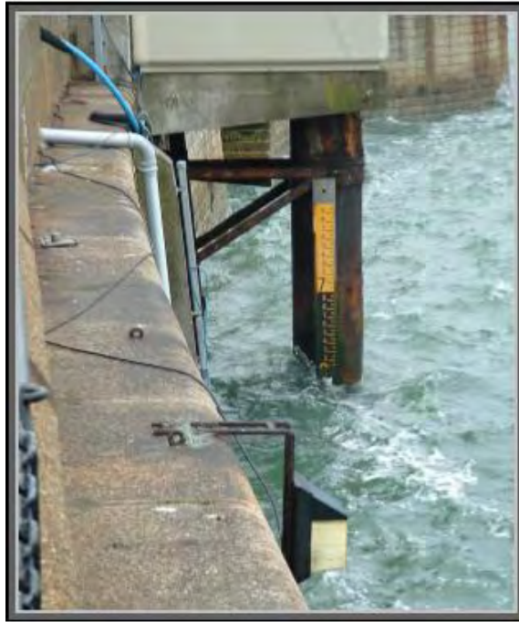
Σχήμα 2.29 Παλιρροϊόμετρο τοποθετημένο σε προβλήτα λιμένα [8].
