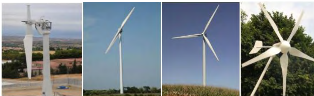
Σχήμα 3.3 Είδη ανεμογεννητριών, μονόπτερη, δίπτερη, τρίπτερη και με πολλά πτερύγια [4].
