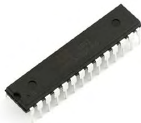
Εικόνα 4.2: Ένα chip μικροελεγκτή. Η επικοινωνία με την πλακέτα και τα εξαρτήματα του κυκλώματος καθώς και η τροφοδοσία γίνεται μέσω των pins. Εδώ βλέπετε ένα AT Mega328-40-pin chip.
