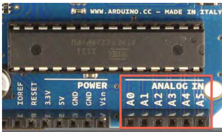
Εικόνα 5.1. Οι 6 αναλογικοί εισοδοί της πλακέτας Arduino Uno
