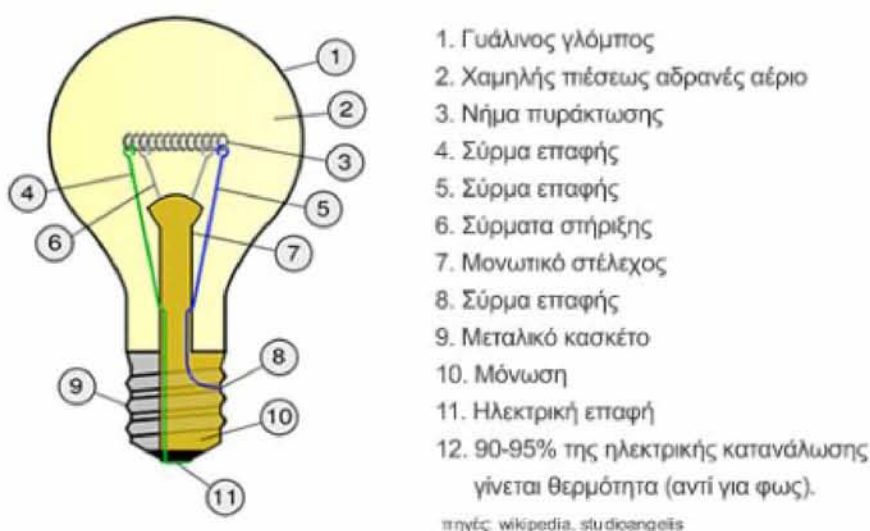
Εικόνα 1: Δομή λαμπτήρα πυρακτώσεως
