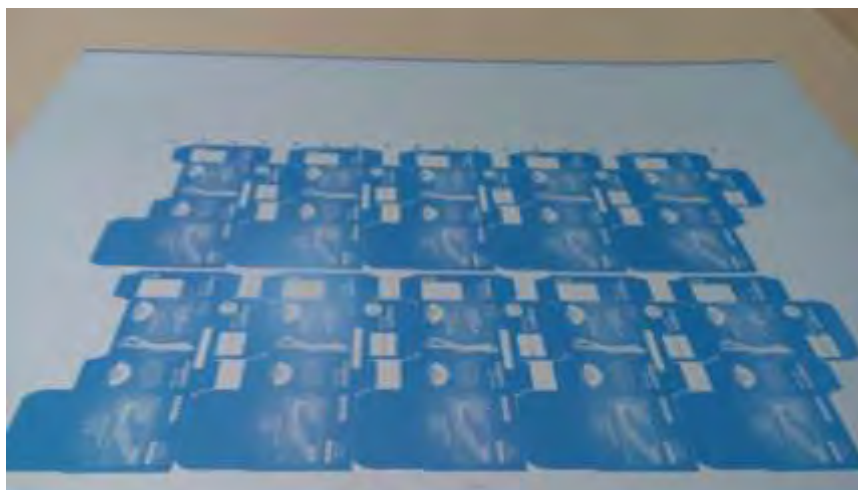
Εικόνα 8. Απεικόνιση της πλάκας εκτύπωσης (επιφάνεια λευκή υδρόφιλη, επιφάνεια χρωματισμένη υδρόφοβη).
