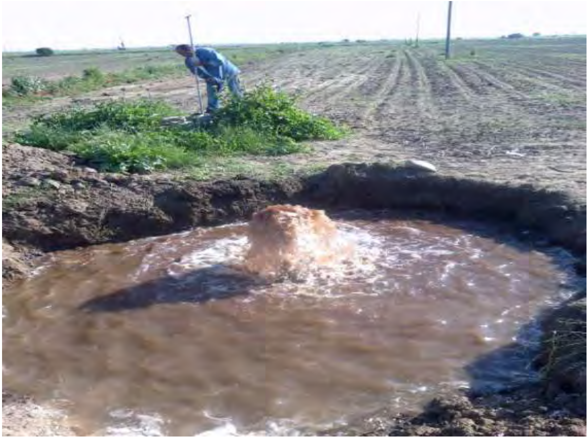
Εικόνα 5.5 βλάβη 5η σπασσιμο υδροληψείας στη ζώνη Σ2
